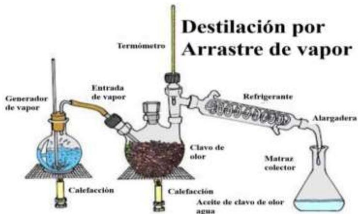
*Nota.* Vista general del método de destilación por arrastre de vapor usando clavo de olor, tomado de (Maigua, 2022).
