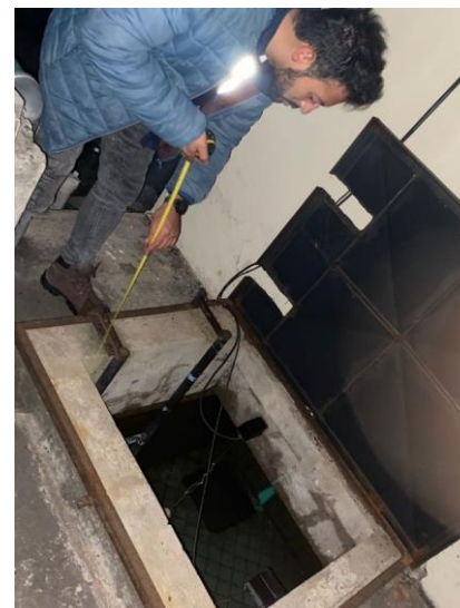
Medición de consumo en la cisterna
