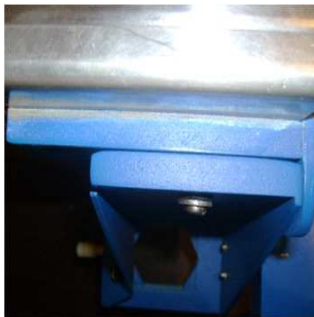
Figura 1.14: Acoplamiento a la base de aluminio.
