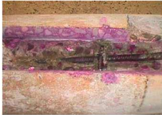
Figura 1.3: Aspecto que presenta una muestra después de adicionarle solución alcohólica de fenolftaleína al 1%.
