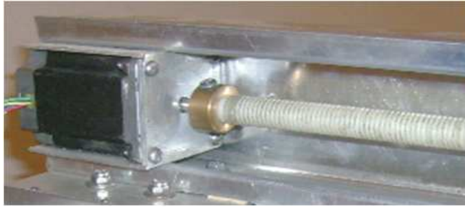
Figura 1.8: Acoplamiento al Motor a Paso.
