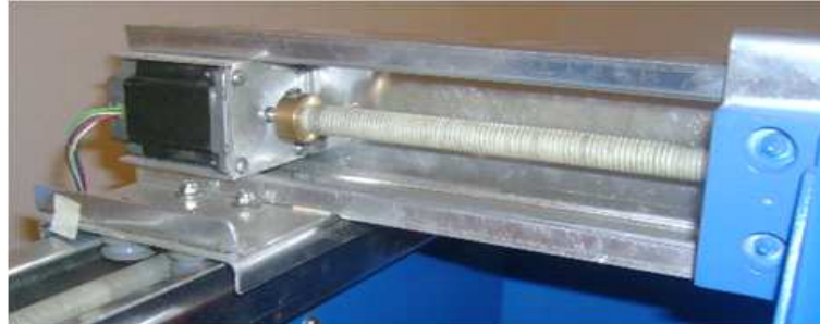
Figura 1.2: Acoplamiento del eje x al eje y.
