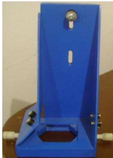
Figura 1.13: Base para permitir el desplazamiento de los sensores.
