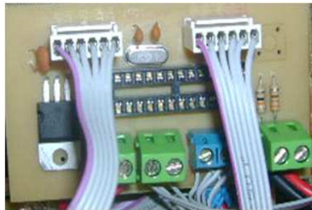
Figura 1.25: Circuito para control de motores.
