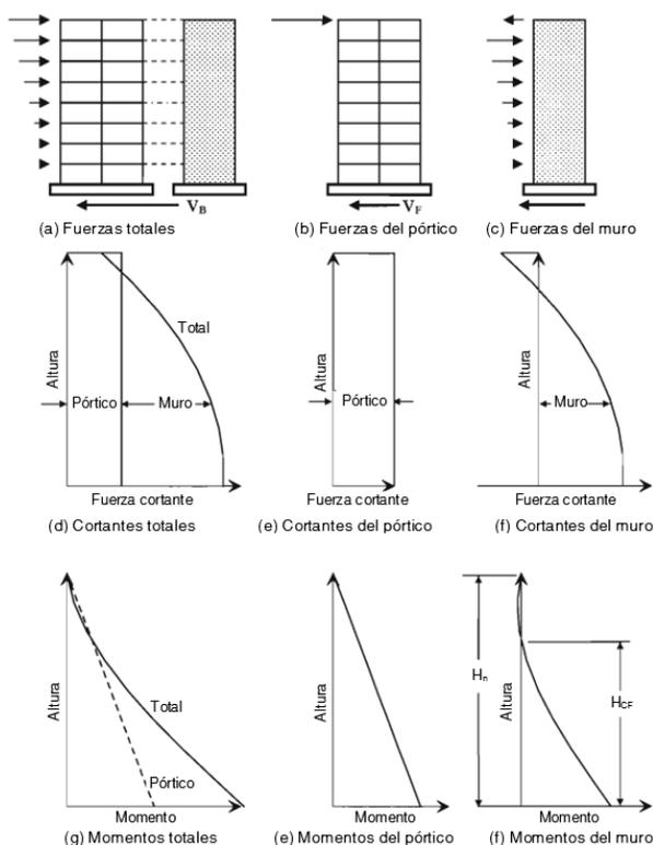
*Nota.* En la imagen se presentan las fuerzas, cortantes y momentos que generan el pórtico y muro de forma individual y en la estructura general. Tomada de Displacement – Based Seismic Design of Structures, por (Priestley, Calvi, & Kowalsky, 2007).
