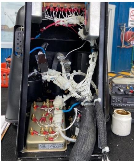
*Nota.* La imagen muestra la conexión de los cables en la consola de instrumentos y su debida seguridad para evitar cortocircuitos.
