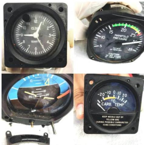
*Nota.* La figura muestra los instrumentos retirados de la consola con suciedad y corrosión.
