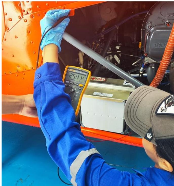
*Nota.* La figura muestra el voltaje emitido por la batería nueva que se colocó en el helicóptero.
