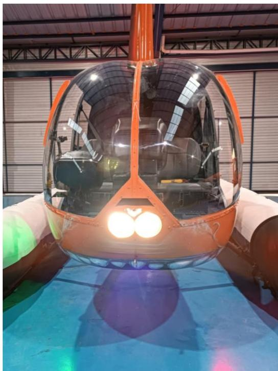
*Nota.* La figura muestra el correcto funcionamiento de las luces del tren de aterrizaje.
