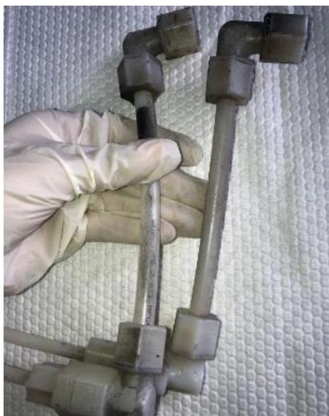
*Nota.* La figura muestra la parte externa de las Líneas Pitot-Estática manchadas con spray.
