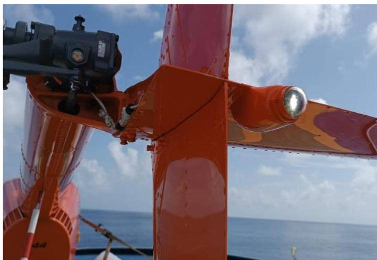
*Nota.* La figura muestra el correcto funcionamiento de la luz de posición de cola.
