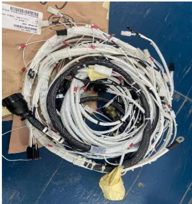
*Nota.* La figura muestra el arnés eléctrico de 28Vcd con los conectores respectivos para su instalación.
