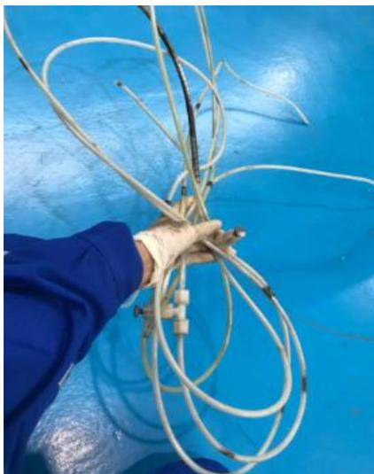
*Nota.* La figura muestra la parte externa de las Líneas Pitot-Estática luego de ser removidas.
