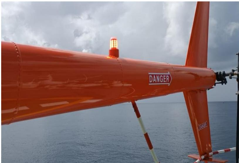
*Nota.* La figura muestra el correcto funcionamiento de la luz estroboscópica.
