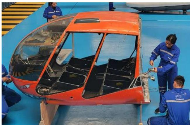
*Nota.* La figura muestra el desmontaje por partes del helicóptero para el cambio de cables.
