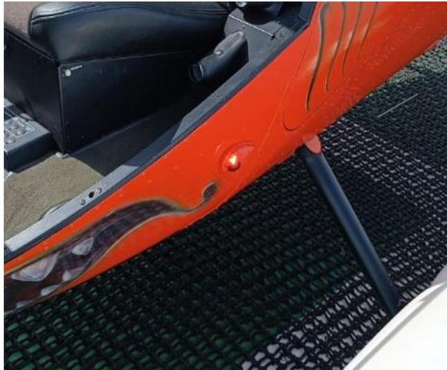
*Nota.* La figura muestra la luz de posición izquierda funcionando después del vuelo.
