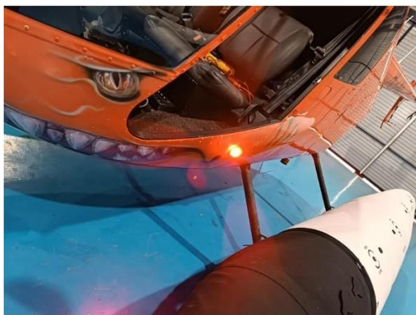
*Nota.* La figura muestra la luz de posición izquierda funcionando antes del vuelo.
