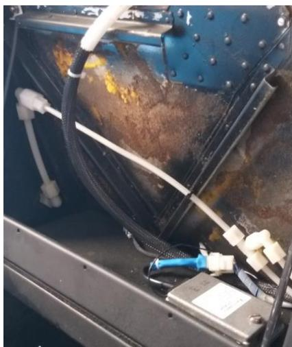
*Nota.* La imagen muestra la conexión realizada de las líneas estáticas después de su limpieza e inspección en la parte izquierda de la aeronave.
