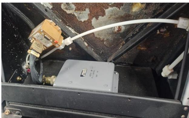
*Nota.* La imagen muestra la conexión realizada de las líneas estáticas después de su limpieza e inspección en el lado derecho de la aeronave.
