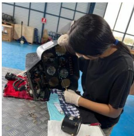
*Nota.* La figura muestra el desmontaje de la consola y los instrumentos de navegación.
