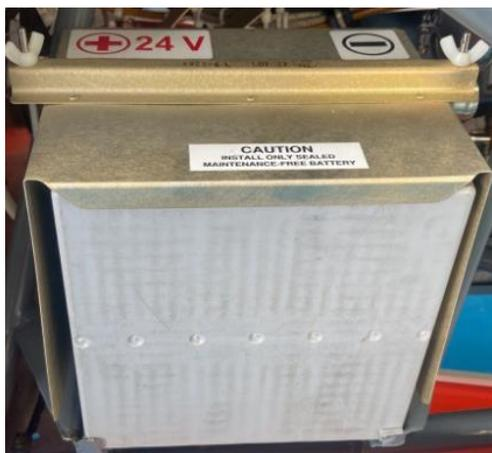
*Nota.* Batería de 24V instalada en el helicóptero
