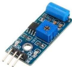
*Nota.* La figura representa el módulo detector SW-420 de vibraciones. Tomado de (*MÓDULO SENSOR DE VIBRACIÓN NC SW-420 – Grupo Electrostore, s. f.*)
