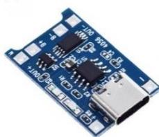
*Nota.* La figura representa el módulo de carga 4056. Tomado de (*TP4056 Tipo C Módulo de carga para batería Lipo 1A – Novatronic, s. f.*)
