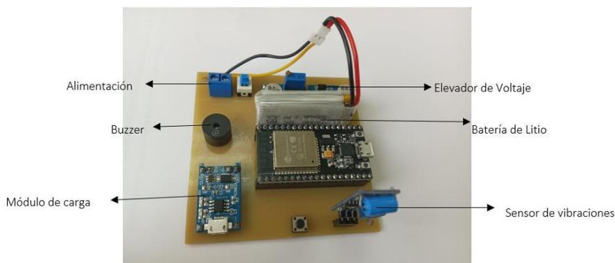
Una vez elaborada la placa de circuito impreso se realizaron pruebas sobre la funcionalidad del circuito:
