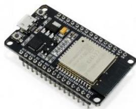
*Nota.* La figura representa el módulo ESP-32. Tomado de (*Mgsystem Módulo ESP32 Wifi Bluetooth Arduino Raspberry Avr - U\$S 8,73, s. f.*)
