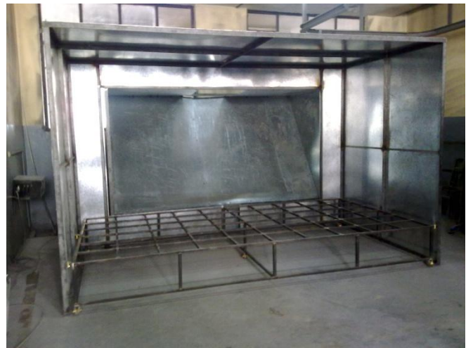
Soporte móvil de muebles metálicos instalado en la cabina
