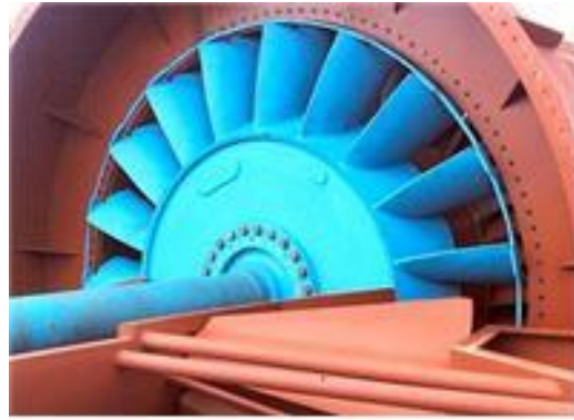
Figura 2.37 Impulsor en un ventilador de flujo mixto
