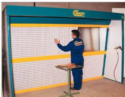
Figura 2.1 Cabina de pintura en polvo 1
