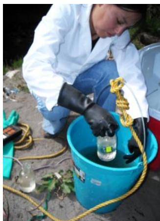
Fotografía N°4: Toma de muestras de agua en botella Winkler
