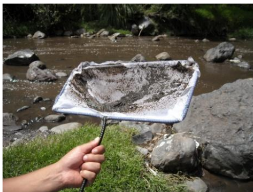
Fotografía N° 5: Red de mano utilizada para el muestreo de macro invertebrados
