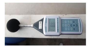
Nota. Instrumento con el cual se llevará a cabo las mediciones de ruido.
