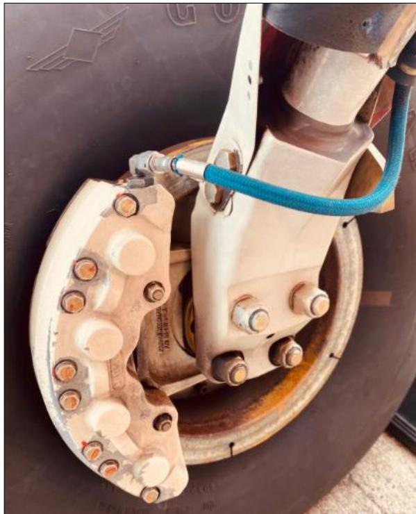
Se procedió a remover los conjuntos de frenos de la aeronave, tal como detalla los procedimientos en el ATA 32. Luego se examinó los revestimientos del freno, para comprobar el deterioro y el desgaste máximo permitido. Dando como resultado un desgaste que no superaba los (2,5 mm), como se muestra en la Figura 48.
