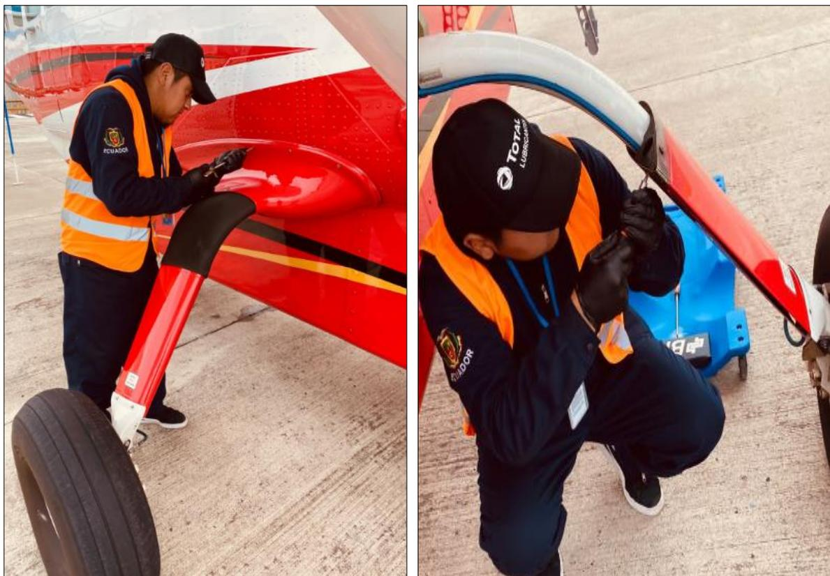
Luego de remover los fairings de los soportes laterales de los trenes, se procedió a relizar la inspección de los fillet seal, que es un sellante de Type I, Class B, como menciona en la página 4 de los procedimientos de instalación de los Spring y como se detalla en la Figura 39.
