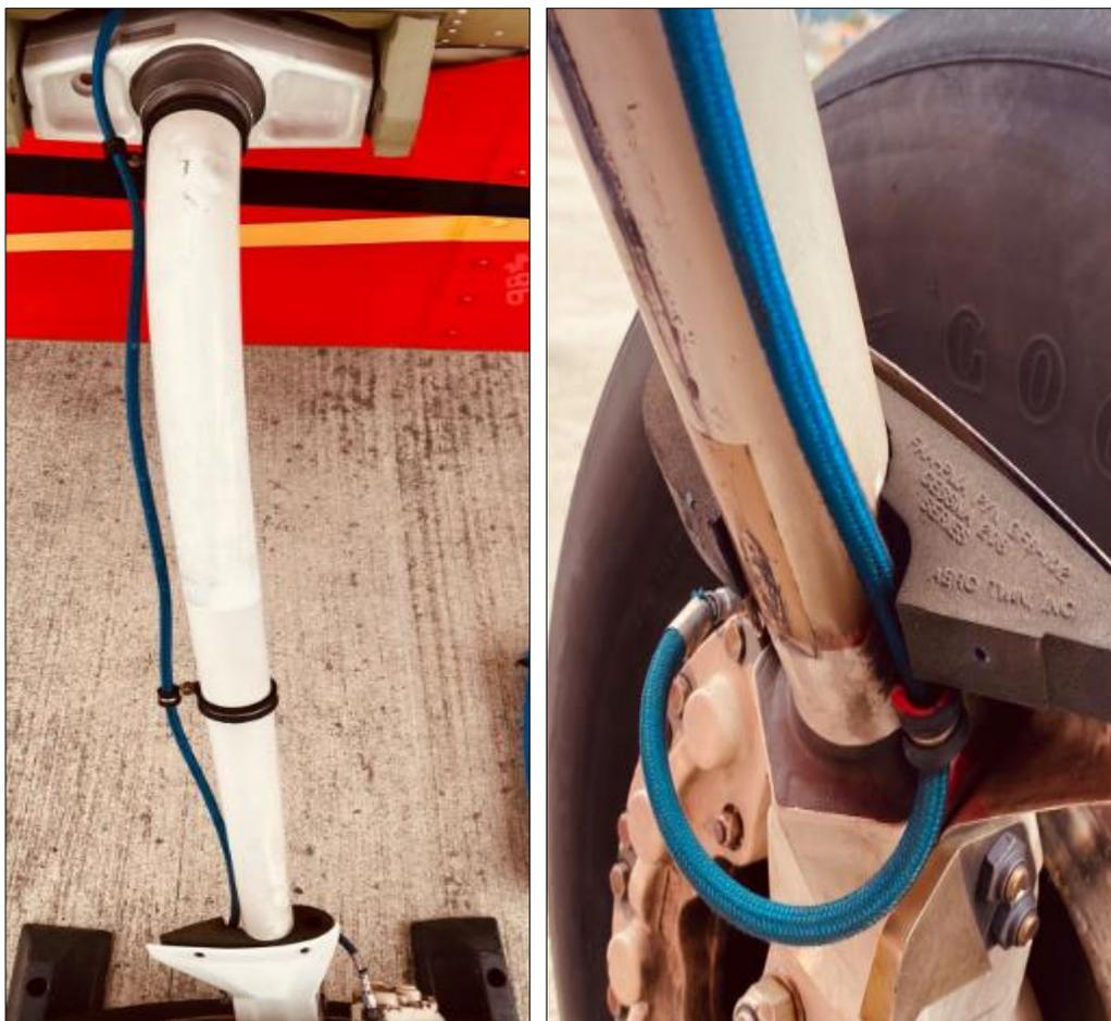
Se realizó la inspección del carenado adyacente a los trenes de aterrizaje en busca de remaches sueltos o de rajaduras, como se observa en la Figura 43, luego de la inspección visual se procedió a aplicar LPS en la superficie de acuerdo a lo que menciona el Manual en el ATA 32-10-00.
