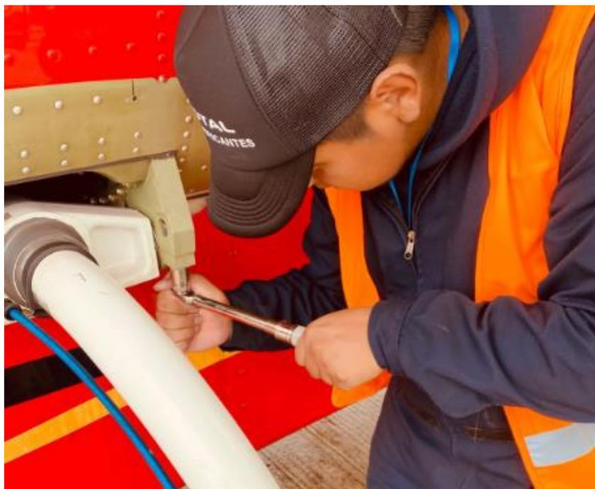
Se verificó que todos los pernos tengan el torque aplicado del manual, que las líneas hidráulicas de los main gear springs and trunnions, estén correctamente instaladas y no presenten fugas, como muestra en la Figura 41.
