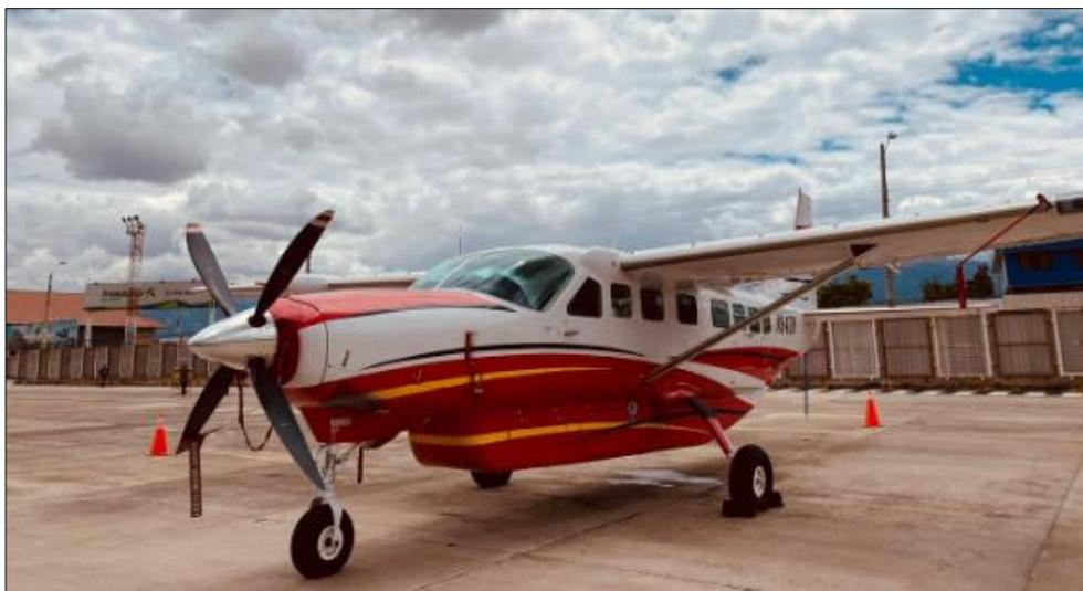
Luego se realizó la respectiva inspección de la aeronave, para saber en qué condiciones se encontraban, especialmente de los trenes de aterrizaje ya que en esos componentes se centrará la inspección de 400 horas. Dicha inspección visual resultó satisfactoria, como muestra la Figura 34.
