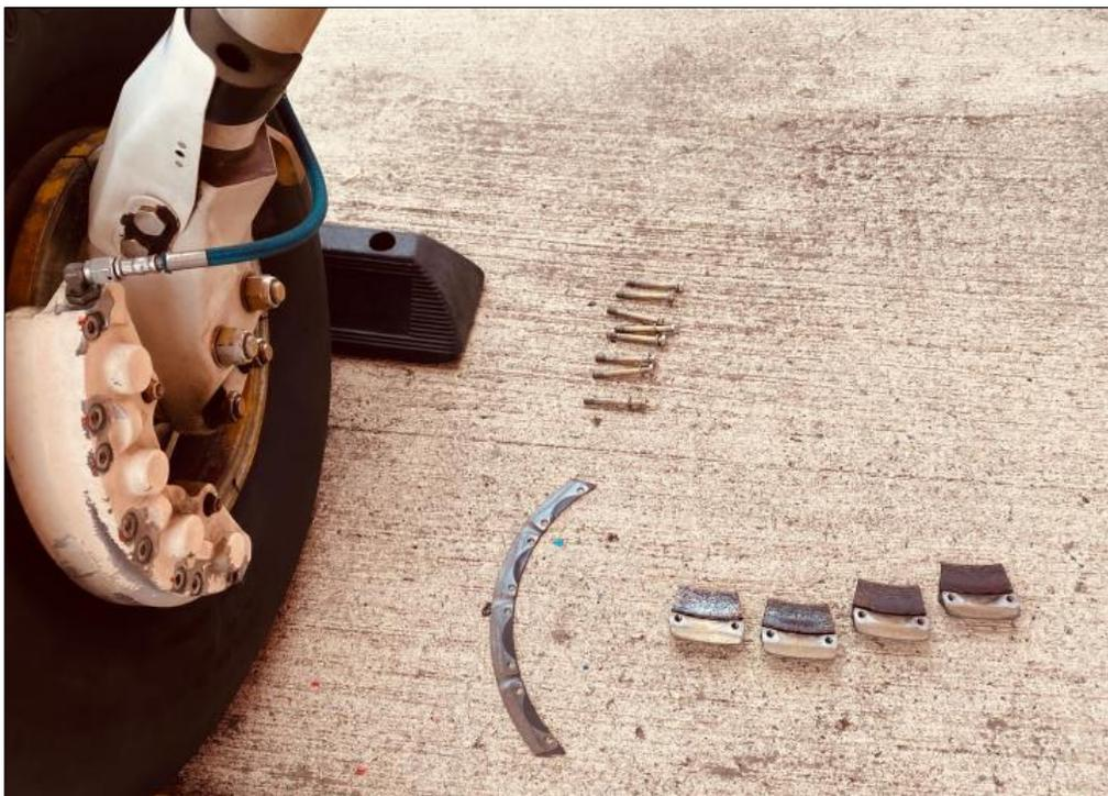
Luego se inspeccionó los orificios de los cilindros de freno en busca de evidencias de rajaduras y deterioro. Los pernos de anclaje y el alojamiento del pistón del freno en la superficie de montaje del perno de anclaje para detectar signos de desgaste, grietas o corrosión.
