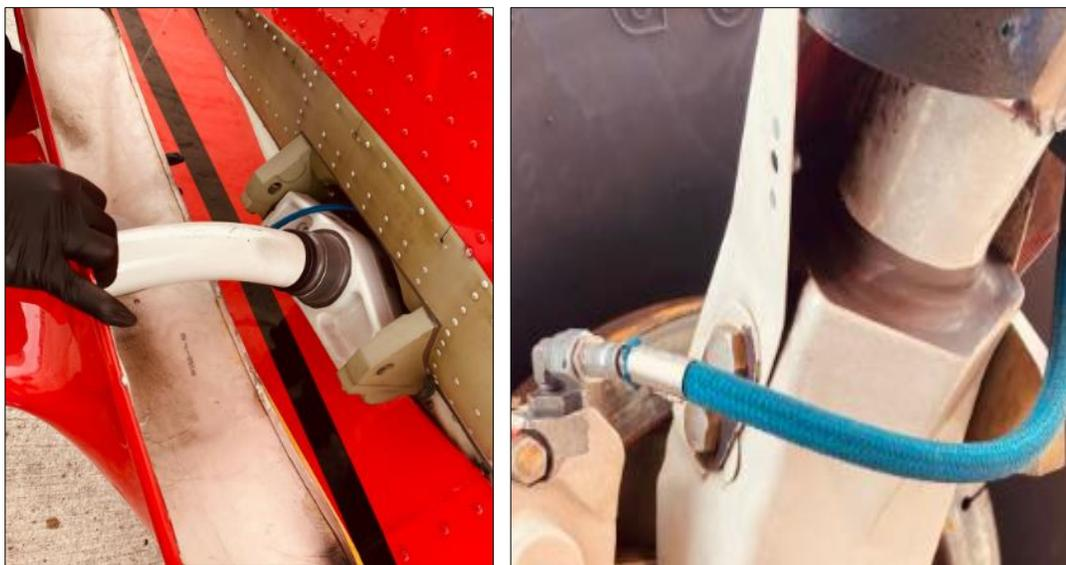
Una vez que se removieron los fairings se procedió inspeccionar los carenados izquierdo y derecho del tren de aterrizaje principal en busca de grietas, desgaste, remaches sueltos, distorsión y tornillería de fijación rota o ausente.
