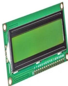
*Nota.* La figura muestra la pantalla LCD con medidas de 16\*2. Tomado de (Geekfactory, 2013)
