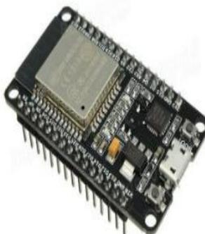
*Nota.* La figura muestra el micro controlador ESP32. Tomado de (Prometec, 2023)
