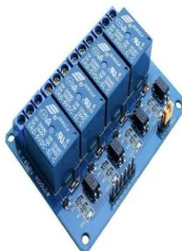
*Nota.* La figura muestra el módulo relé de cuatro canales que se implementó dentro de la máquina. Tomado de (Avelectronics, 2023)
