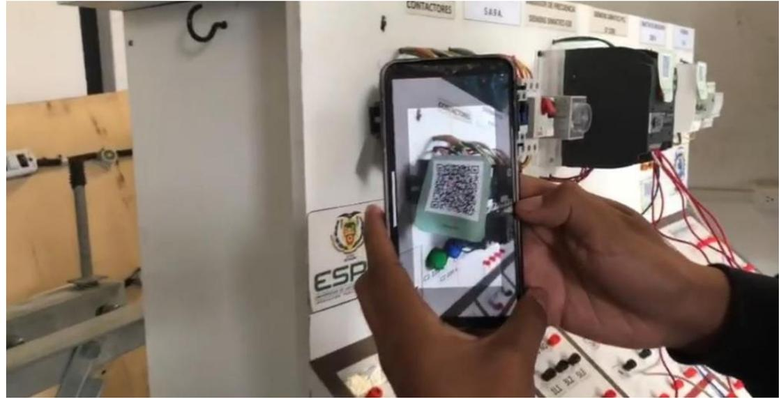
Se realiza la respectiva prueba del disparador, ya que al enfocar la cámara directamente al código QR, esta desplegará la información necesaria del tablero de automatización que se tomó como prueba para el launcher "ScanQREspe".
