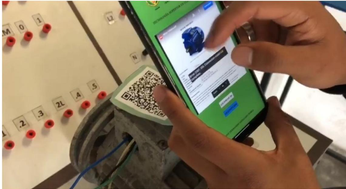
Después de haber escaneado el código QR directamente del dispositivo celular, se desplegará un documento pdf con la información necesaria, llevando en si en el documento sus características y funcionamiento de cada componente que contiene dicho tablero.
