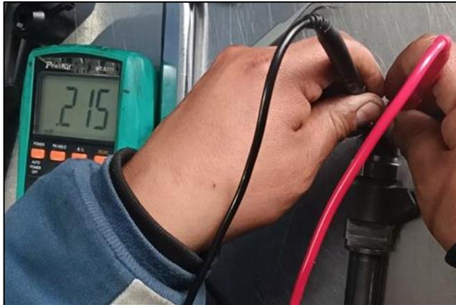
La medición de la Inductancia se realiza con el inyector sin señal, para este tipo de inyectores los valores se encuentran entre  $0,23\text{mH}$  a  $0,19\text{mH}$
