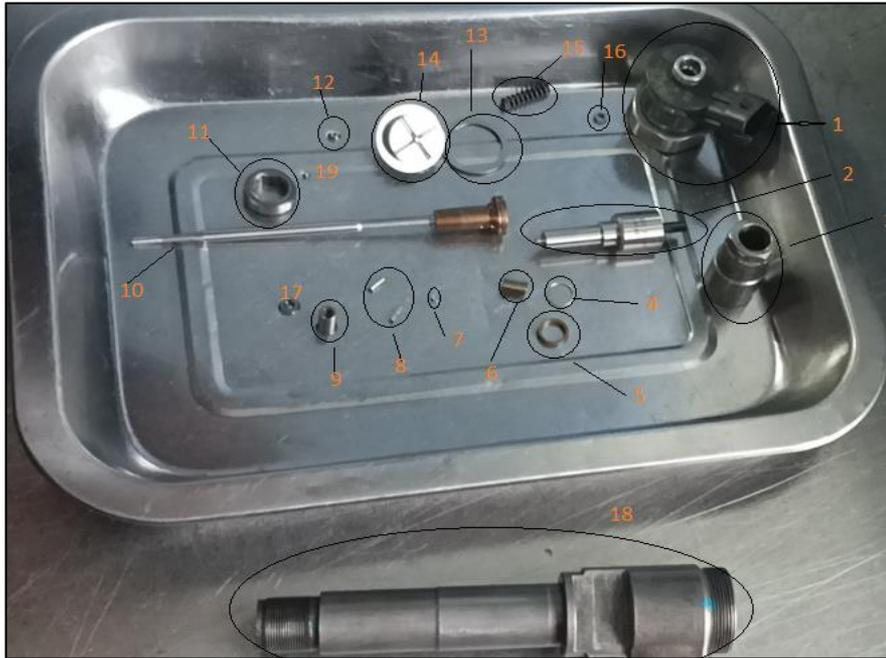
Es utilizado para vehículos de turismo y por lo general se utiliza en el vehículo Mazda modelo BT- 50 en la figura 59 se muestra el despiece del inyector.
