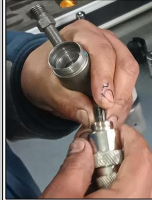
Emplear la herramienta de montaje del grupo de válvula y asegurarse de presionar suavemente con la palma de la mano.
