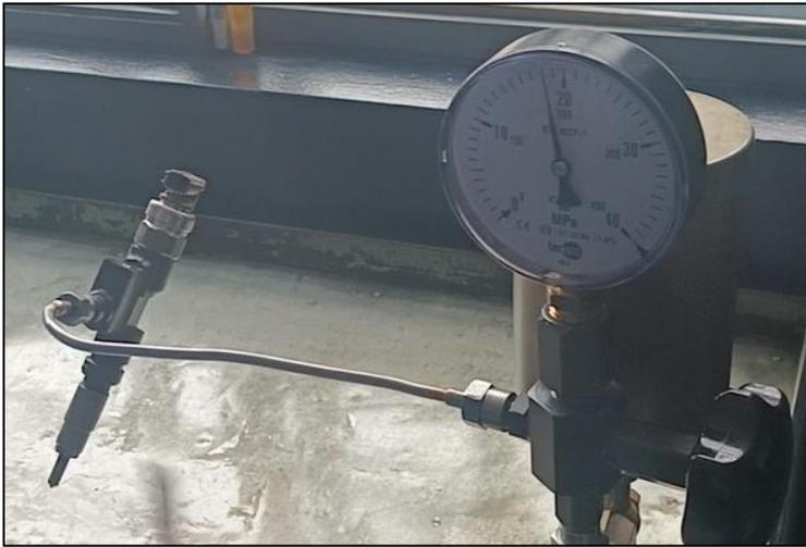
Para la prueba se debe accionar la palanca de mando de la bomba del comprobador hasta obtener una presión en el inyector de aproximadamente 10 bar, y se cerrará la válvula de paso de combustible, en estas condiciones, debe observarse un descenso lento de la aguja del reloj comprobador, que indica el nivel de fuga del retorno.
