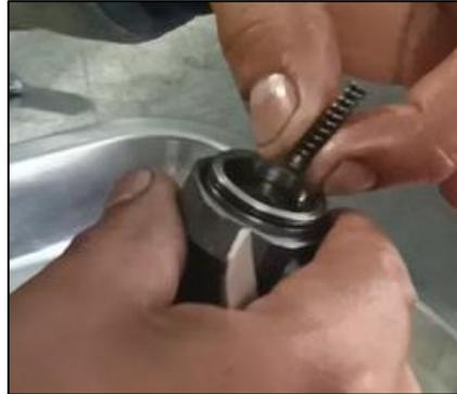
Enroscar la bobina con el cuerpo del inyector.
