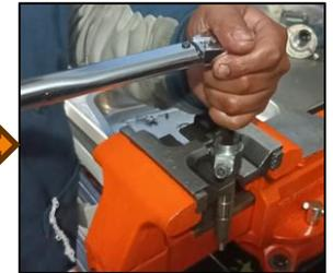
Con el torque respectivo ajustar la bobina al cuerpo del inyector
