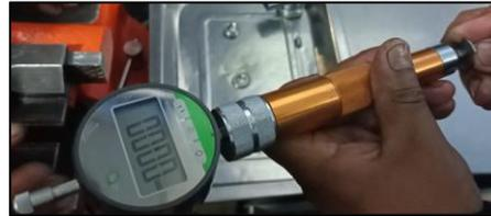
Primera mediada del inducido debe ser entre el rango de 0.50 a 0.60 mm
