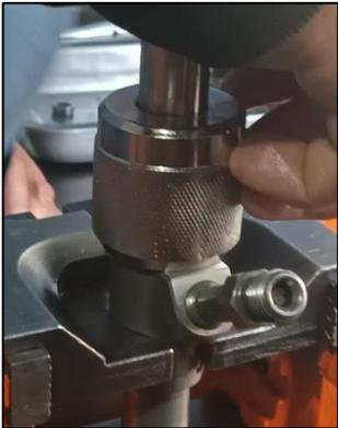
Insertar la válvula con el embolo en el cuerpo del inyector de manera cómo fue extraído.
