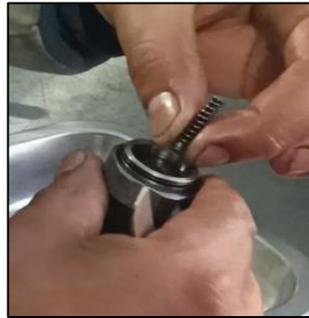
Posicionar el muelle para calibre debajo del inducido.
