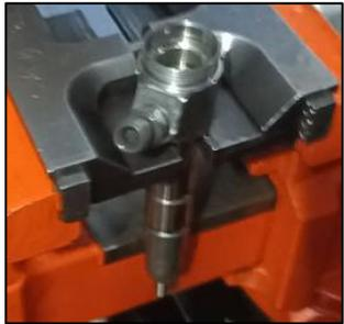
Introducir válvula y vástago dentro del cuerpo del inyector
