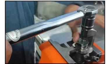
El anillo de ajuste VFK tiene un rango entre 1.70 a 1.80 mm
