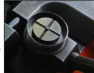
Montar la bobina al cuerpo del inyector dando un torque de 35 Nm
