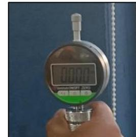
Fijar el micrómetro sobre el cuerpo magnético del inyector e introducir el husillo
