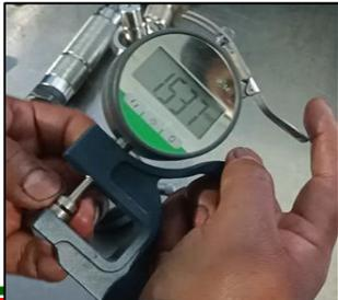
El de ajuste AH deberá de remplazarse hasta obtener las medidas establecidas para el recorrido de la esfera de válvula.
