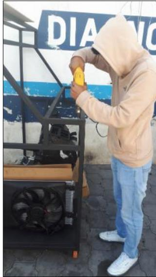
*Nota.* Proceso de perforación en la estructura con un taladro para la instalación de las planchas.
