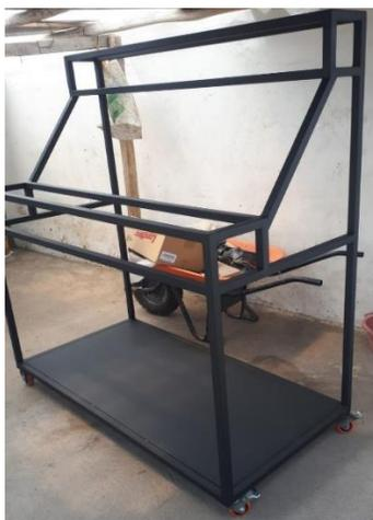
*Nota.* Instalación de garruchas para 1000kg y terminados finales de la estructura.
