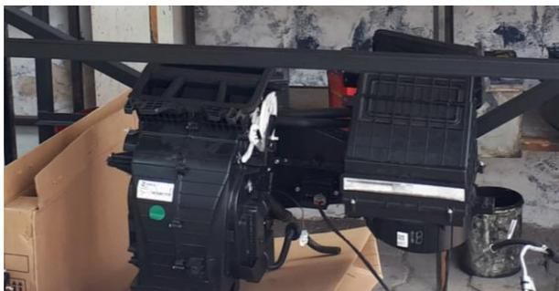
*Nota.* El bloque de aire acondicionado representa alrededor del 40% del sistema de aire acondicionado, debido a que en él se encuentran instalados los siguientes componentes: soplador, evaporador, válvula de expansión y módulos eléctricos.
