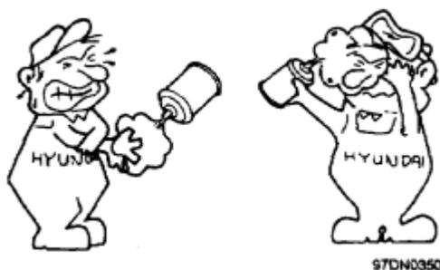
*Nota.* En la fotografía se puede observar que al no usar guantes de seguridad, podemos hacernos daño por causa de la congelación del gas refrigerante. (HYUNDAI MOTOR COMPANY, 1995).
