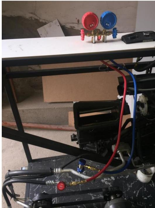
*Nota.* En la fotografía se puede observar la conexión de las mangueras de alta (rojo) como de baja (azul) presión.
