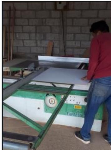
*Nota.* Proceso de corte de las planchas MDF en una máquina especializada.
