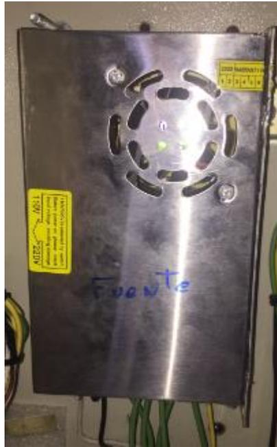
*Nota.* Fuente de poder de 220V a 12V o 110V a 12V, con ventilación en la parte superior.
