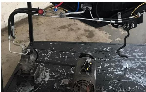
*Nota.* La cañería de menor diámetro es la de alta presión y la que permite la salida del refrigerante en estado gaseoso desde el compresor, mientras que la cañería de mayor diámetro es la de baja presión y es la que permite el retorno del refrigerante.
