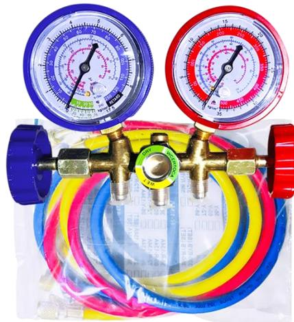
*Nota.* En la figura se puede identificar un manómetro de alta presión (rojo) y otro de baja presión (azul). Tomado de (HERSOL, 2023).
