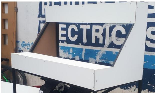
*Nota.* Las planchas de MDF sirven de soporte para la instalación de los accesorios y elementos eléctricos del sistema de aire acondicionado.
