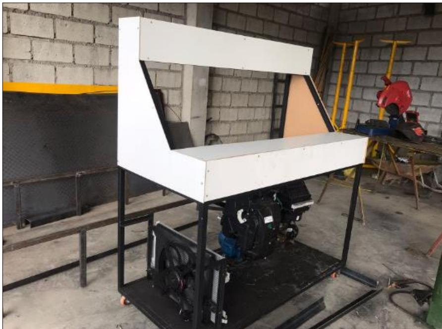
*Nota.* Recubrimiento completo en la parte superior de la estructura con MDF.
