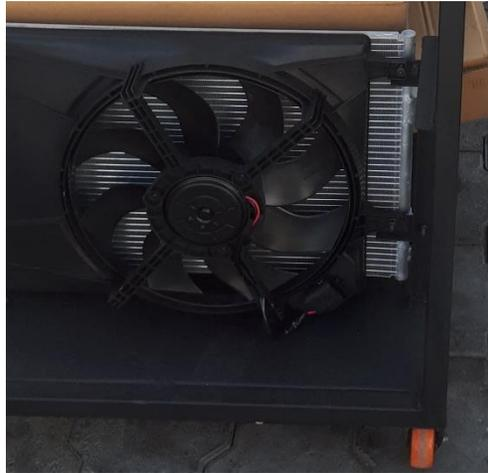
*Nota.* El ventilador tiene que ir instalado en la parte posterior del condensador con la finalidad de disipar la mayor cantidad de calor producido por el refrigerante R134a.
