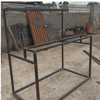
*Nota.* Proceso de corte y soldado de los tubos cuadrados y ángulos de la estructura.
