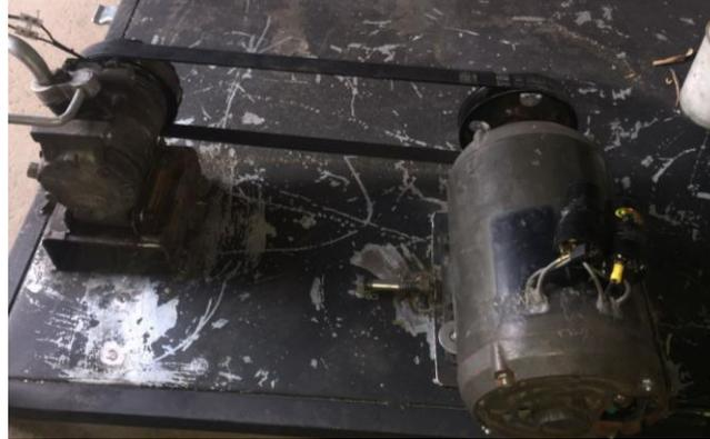
*Nota.* La distancia entre el compresor y el motor eléctrico es definida por la banda de transmisión, además es fundamental que exista una adecuada tensión de la misma.
