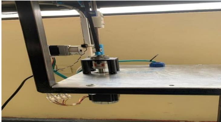
Para terminar con el montaje de la plegadora, se procede a realizar las conexiones de los componentes eléctricos y electrónicos, motores, drivers, tarjeta de control y fuente de alimentación. En la Figura 44 se indica la implementación de los componentes previamente seleccionados.
