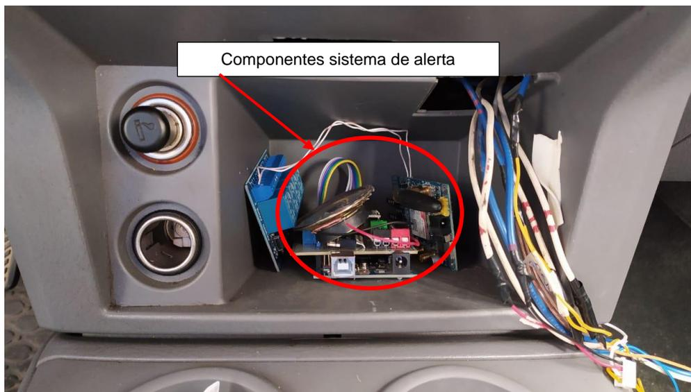
*Nota.* En la figura se observa la instalación de los componentes que conforman parte del sistema de alerta en el espacio inferior del mando central del salpicadero.
