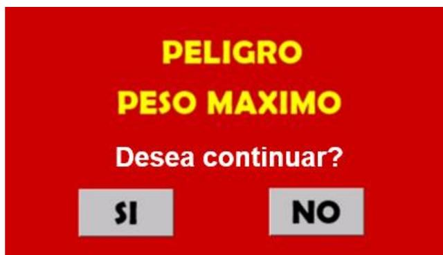
*Nota.* En la figura se observa la interfaz que el usuario puede interactuar dándole las alternativas de SI o NO para poder circular a pesar de llevar una carga que excede los límites permitidos y así controlar la sobrecarga del vehículo.
