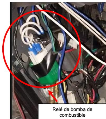
*Nota.* En la figura se muestra el relé de la bomba de combustible instalada en el vehículo el mismo que forma parte del sistema de control del proyecto.
