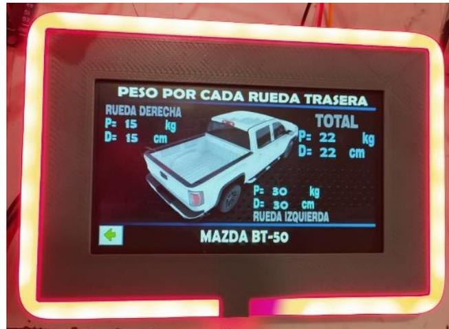
*Nota.* En la figura se observa que la tira LED cambia de estado a un color tomate indicando al usuario que está próximo a alcanzar el límite de sobrecarga programado.
