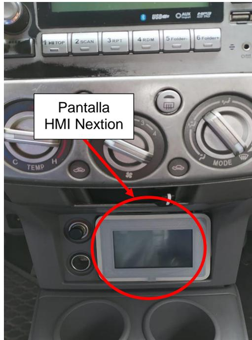
*Nota.* En la figura se muestra la instalación de la pantalla con su base en la parte inferior del mando central de la cabina.
