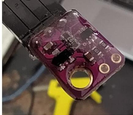
*Nota.* En la figura se observa la aplicación de resina epoxi por parte de los autores en la parte inferior del sensor de distancia para evitar falsos contactos y cortocircuitos.
