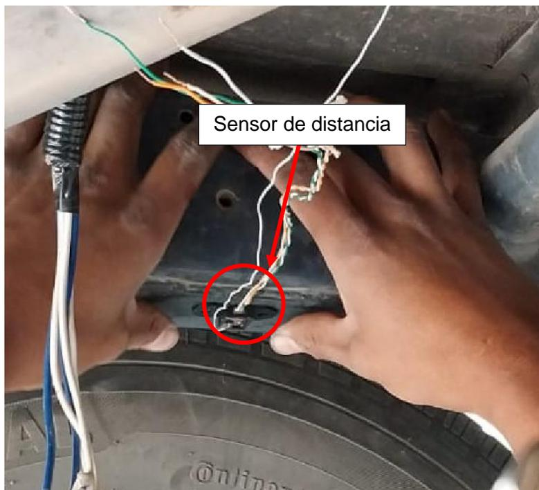
*Nota.* En la figura se puede observar la instalación de uno de los sensores de distancia en la parte inferior del chasis del vehículo.
