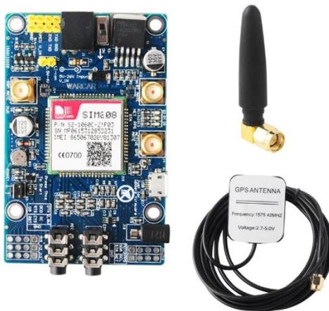
*Nota.* En la imagen se visualiza el módulo GSM SIM 808 a usar en la construcción del sistema.
