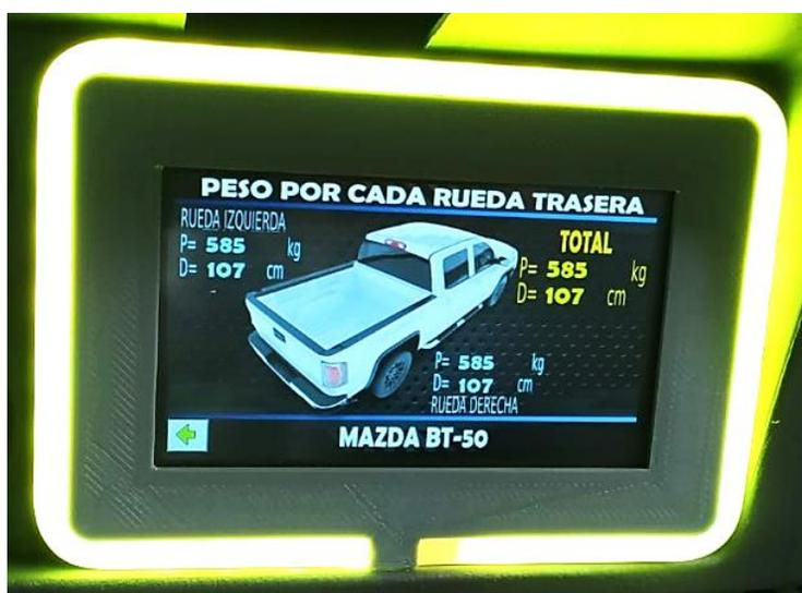
*Nota.* En la figura se observa que en este nivel la tira LED cambia de estado a un color amarillo indicando una señal de advertencia al conductor de la carga en la que se encuentra el vehículo.
