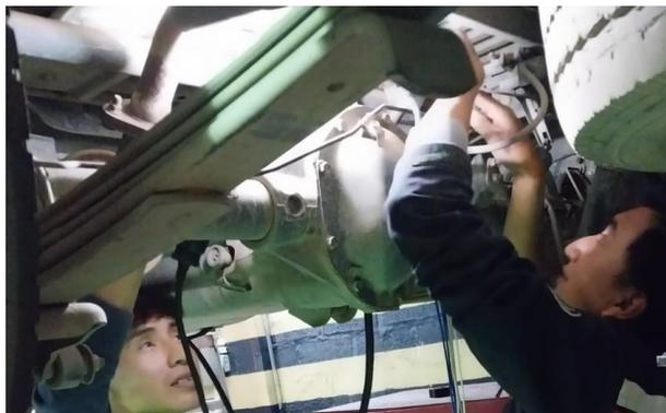
*Nota.* En la figura se puede observar a los autores conduciendo el cable por debajo del vehículo para la conexión de los componentes.
