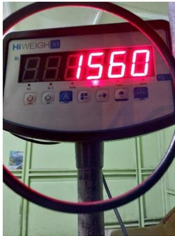
*Nota.* En la figura se muestra el valor de peso total del vehículo sin carga ni ocupantes obtenido de la báscula industrial utilizada para la presente prueba.
