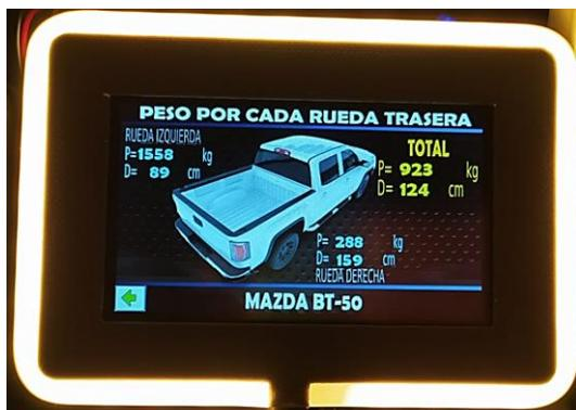
*Nota.* En la imagen se observa la pantalla HMI fijada en la base que fue diseñada y manufacturada para su soporte y protección.
