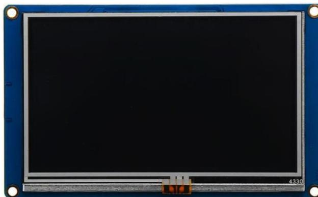
*Nota.* En la figura se muestra la estructura física de la pantalla Nextion de 4.3 pulgadas, usada en el desarrollo del proyecto. Tomado de (Nextion, 2023)
