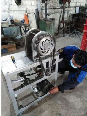
*Nota.* Se está realizando el Montaje del motor eléctrico, catalina y cadena del prototipo.
