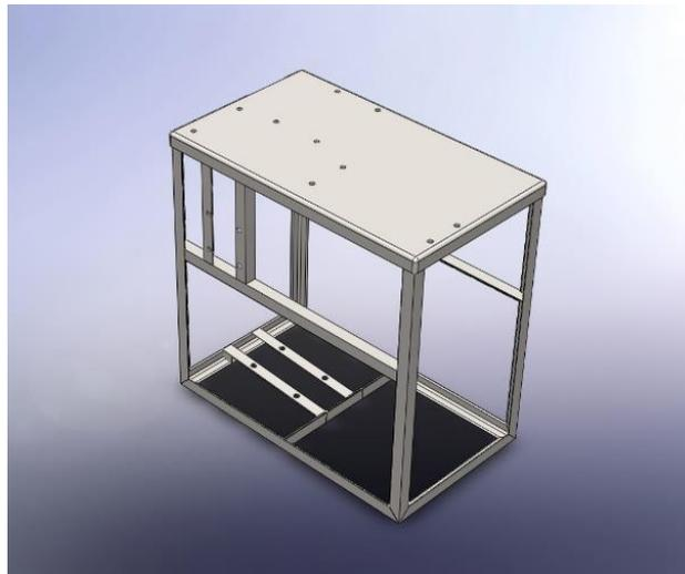
Realizado el diseño se concluyó que la estructura es resistente para colocar los diferentes elementos en las partes interiores y exteriores que ayudaran en el proceso de corte de la caña de azúcar.
