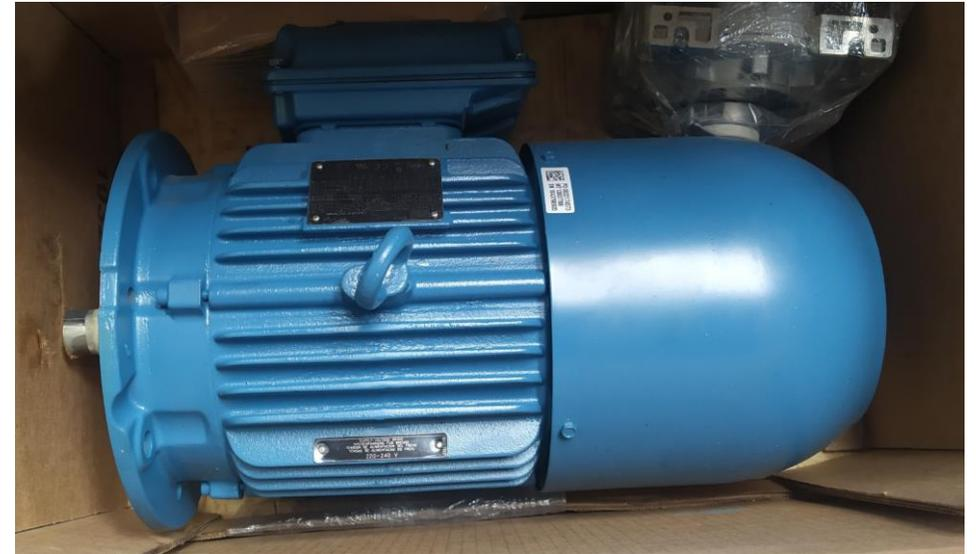
*Nota.* En la figura 17 se observa el motor eléctrico con freno de 7,5 HP a 1740 rpm que será utilizado en el sistema de elevación del conveyor.
