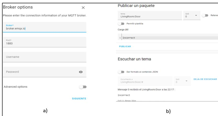
*Nota.* En la parte a) se muestra la configuración del Broker MQTT en Home Assistant y en b) la comprobación si se está suscrito/publicando en un tema en específico.
