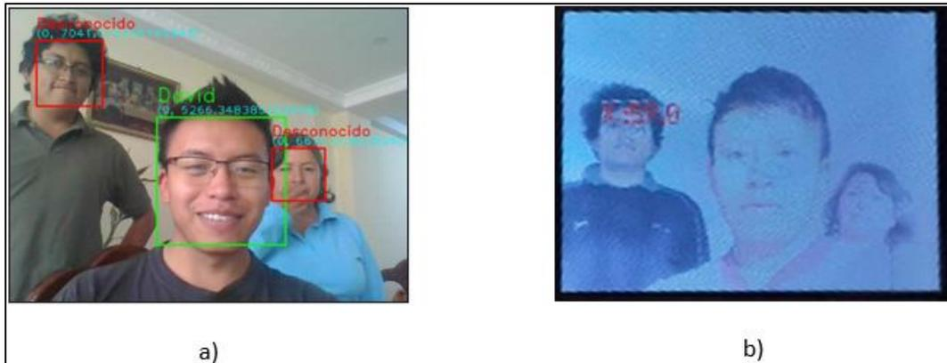
*Nota.* En la Figura se pueden observar el funcionamiento del programa en a) software y b) hardware con tres rostros al mismo tiempo
