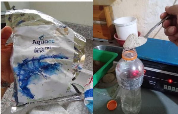
Preparación de aglutinante y disolución de levadura y selenio
