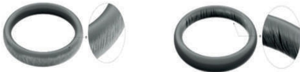
Nota. La figura muestra un daño por abrasión (izquierda) y un daño por degradación química (derecha). Tomado de (Zeng et al., 2021).
