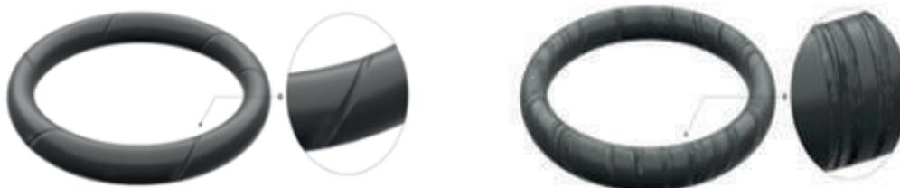
*Nota.* La figura muestra un daño por fallo en espiral (izquierda) y por degradación térmica (derecha). Tomado de (Zeng et al., 2021).
