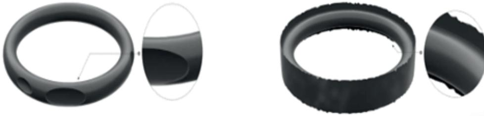
*Nota.* La figura muestra un daño por mala instalación (izquierda) y un daño por extrusión - mordisqueado (derecha). Tomado de (Zeng et al., 2021).
