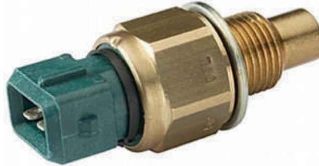
**Sensor de temperatura exterior:** Está encargado de recoger el valor la temperatura del medio exterior, su ubicación se da en lugares donde su lectura no pueda ser influenciada por el calor generado por el motor. De manera que, si la temperatura exterior es demasiado baja, impide la activación del aire acondicionado.
