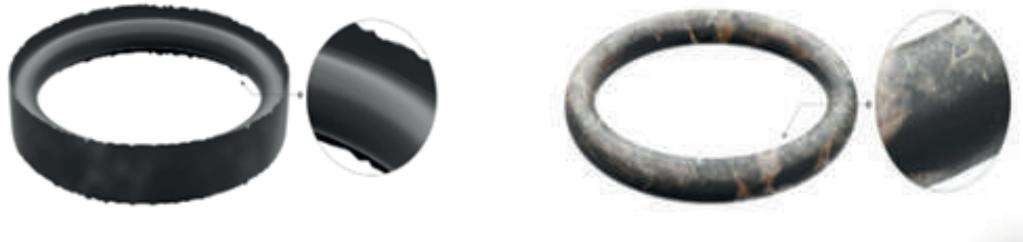
*Nota.* La figura muestra un daño por extrusión térmica (izquierda) y por degradación UV (derecha). Tomado de (Zeng et al., 2021).
