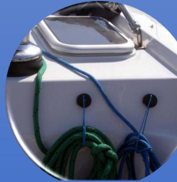
Jarcia de labor se ve expuesta al deterioro, por desgaste de la cabuyería.
