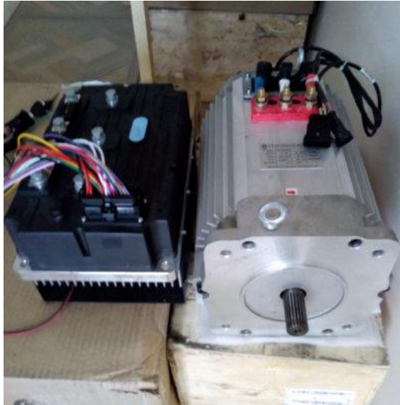
Kit de propulsión eléctrica de 96V
