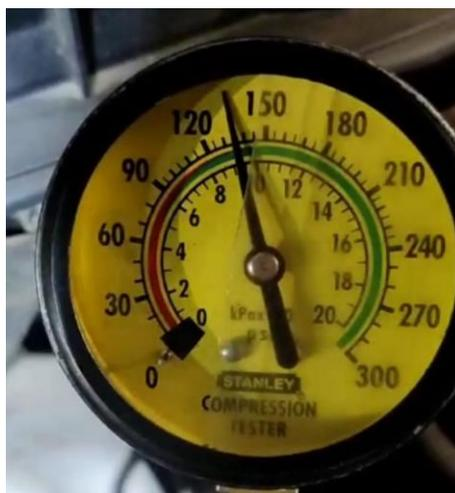
*Nota.* Se observa un compresómetro con el valor de compresión de cada cilindro del motor.
