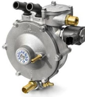
*Nota.* Se observa un reductor de la marca Landi Renzo, produce una reducción de presión en una sola etapa, tiene una válvula solenoide y filtros integrados. Tomado de:
