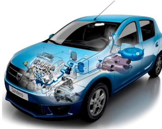
*Nota.* El gráfico muestra los principales componentes del sistema, 1 toma de llenado, 2 depósito de GLP, 3 multiválvula, 4 cañería, 5 válvula de paso, 6 evaporador, 7 sensor de velocidad, 8 inyectores, 9 múltiple de admisión, 10 control electrónico, 11 reductor. Tomado de (LANDIRENZO, Sistema de GLP para motores de inyección directa, s.f.)
