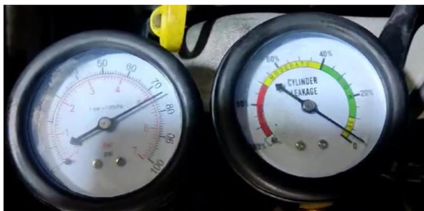
*Nota.* Se observa un manómetro y el comprobador de fugas utilizados para medir el porcentaje de fugas existentes en cada cilindro.
