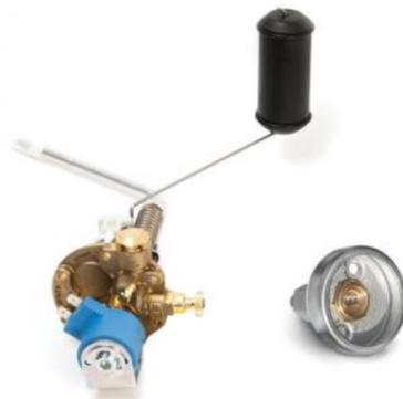
*Nota.* Se puede observar que la multiválvula tiene la función de suministrar el GLP regulando la presión hasta un máximo de 21 bar. *Tomado de* (LANDIRENZO, Sistema de GLP para motores de inyección directa, s.f.)
