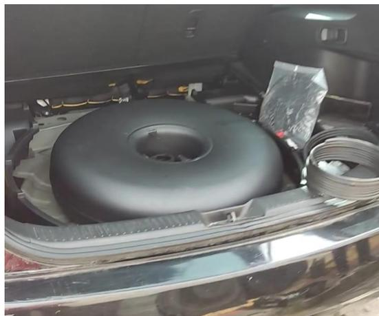
*Nota.* El depósito toroidal se instaló, la fijación fue compleja, sin embargo, no representó un gran problema en el apartado de seguridad.
