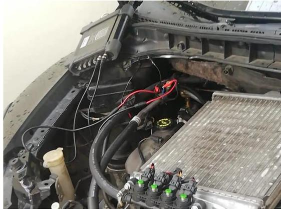
*Nota.* La conexión del osciloscopio al positivo y control de masa que sirvió como base para determinar el número de revoluciones las que el vehículo realiza el cambio de combustible siendo en el intervalo de 1500-2000 rpm.
