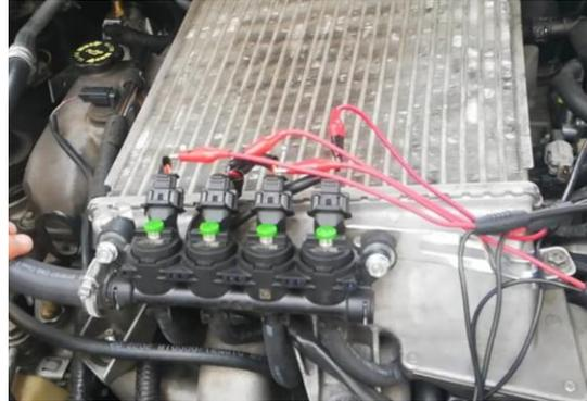
*Nota.* Se observa la conexión con la cual se verificó los pulsos de inyección de los inyectores de GLP.
