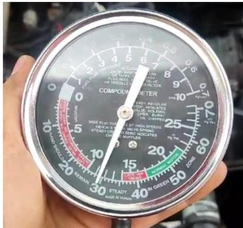
*Nota.* Se observa un manómetro que determinó las condiciones de vacío que generó el motor que tiene valores de inHg.
