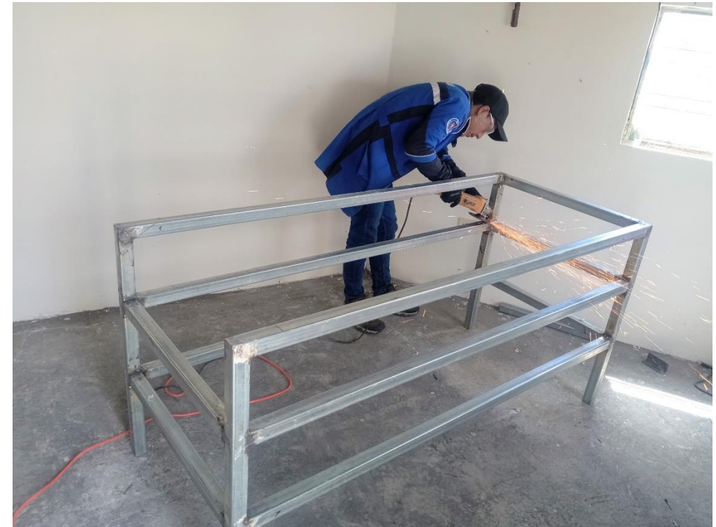
Soldadura y pulido
