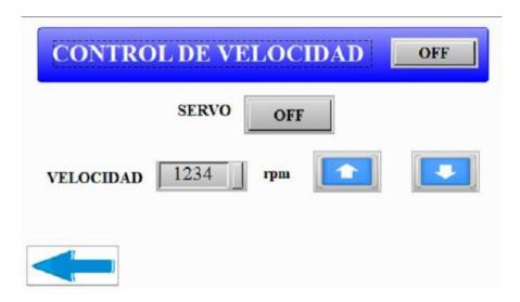
Nota. En la figura se muestra la pantalla de control de velocidad con diferentes opciones para modificar la velocidad.
