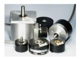
Nota. En la figura se aprecian diversos encoder para diferentes tipos de servomotores, cabe señalar que el encoder se encuentra en la parte posterior del servomotor en el interior de la carcasa del mismo. Tomado de Hernández Orozco et al., (2015)
