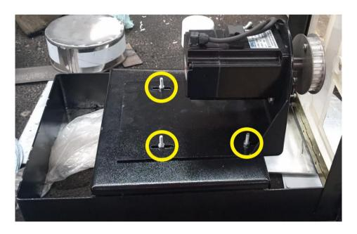
Nota. En la figura se aprecia los tornillos de fijación de la base del servomotor la cual puede variar su profundidad.
