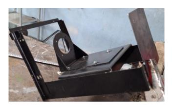
Nota. En la figura se indica la carcasa mecanizada, armada de acero de 2 mm.
