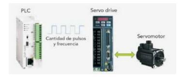
Nota. En la figura se aprecia los elementos necesarios para poder realizar el control de posición y velocidad. Tomado de Lamponi (2017)
