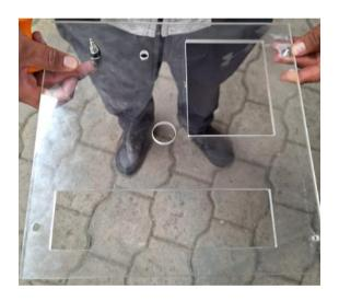
Nota. En la figura se muestra una lámina de acrílico cortada con láser.
