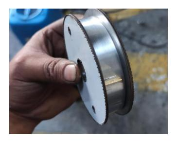
Nota. Se observa en la figura una rueda lisa que posteriormente se realizará un proceso de mecanizado de ranurado que dará a lugar a los dientes que embona en la banda de distribución.
