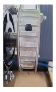
Nota. La figura mostrada muestra un taladrado en donde irá un prisionero que se encarga de la fijación con el eje.
