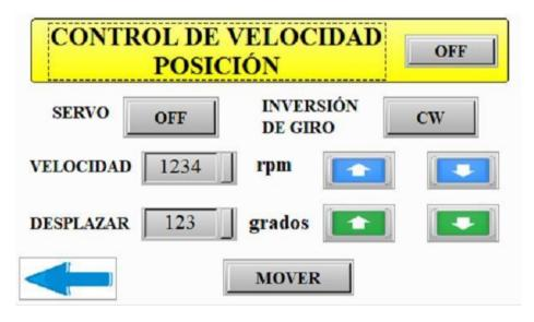
Nota. La figura expuesta muestra la pantalla de control de posicionamiento que además integra la velocidad del desplazamiento.
