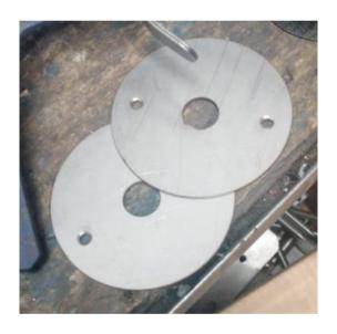
Nota. En la figura se aprecian dos discos de aluminio que serán los soportes de la banda con respecto a la polea.
