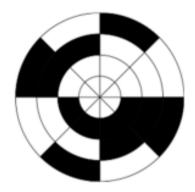
Nota. En la figura se visualiza el disco óptico compuesto de zonas dispuestas radialmente.
