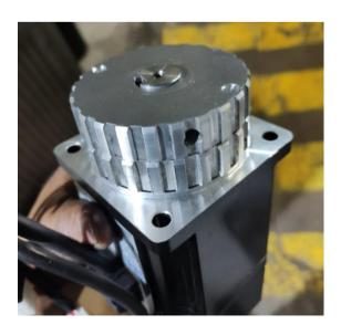
Nota. En la figura se aprecia que la polea se inserta milimétricamente con el eje del servomotor, demostrando que el diámetro del agujero respecto al eje varía menos de un milímetro.
