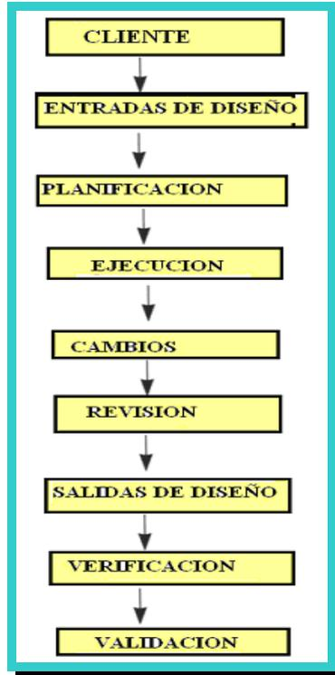
**Figura 2.10.1.1 Elementos de Entrada del Diseño y Desarrollo**
