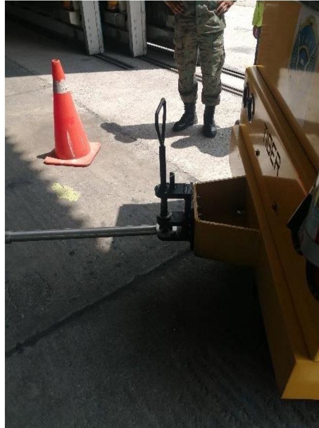
Ajuste barra de remolque – remolcador
