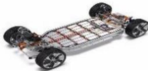
*Nota.* En la figura 11 podemos observar la batería de un vehículo eléctrico. Tomado de (Aldaz & Chancusi , 2021).
