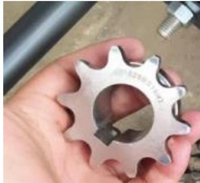
*Nota.* La figura 36 muestra el piñón que se va implementar al motor eléctrico.
