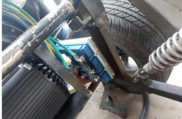
*Nota.* La figura 38 muestra la instalación del controlador con sus respectivos soportes y bases en el bastidor del prototipo.
