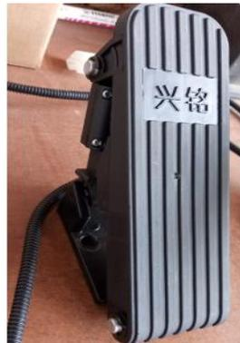
*Nota.* En la figura 42 muestra el pedal del acelerador de forma que será adjunto en el prototipo.
