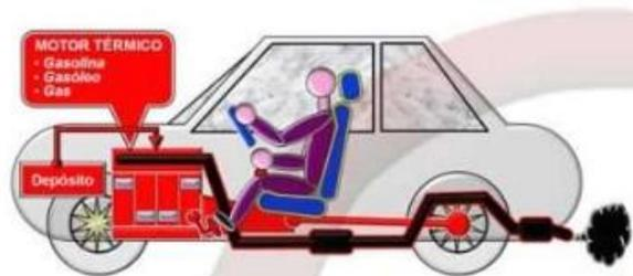
*Nota.* La figura 25 muestra Tipo de propulsión térmica en vehículos. Tomado de (vehículo, Tipos de propulsión en el automóvil, 2021).
