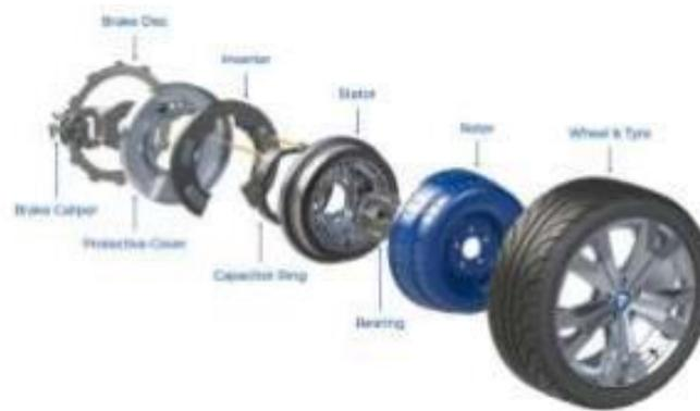
*Nota.* La figura 29 muestra el tipo de transmisión por medio del motor en las ruedas. Tomado de (Sarango, Implementación de un sistema de propulsión eléctrica de un buggy para la carrera de Tecnología., 2022).
