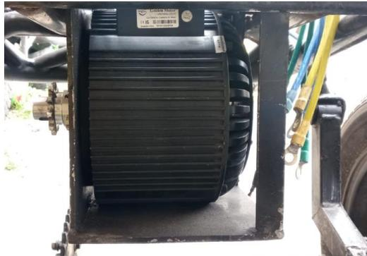
*Nota.* La figura 35 muestra el soporté construido en el bastidor para el motor.
