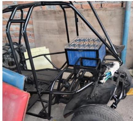
*Nota.* La figura 40 muestra la instalación de la batería en el bastidor del prototipo con sus respectivos soportes y bases.
