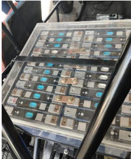
*Nota.* La figura 41 muestra la colocación de las baterías en su base protectora con conexión en serie.
