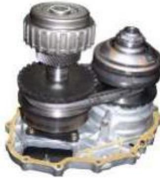
*Nota.* La figura 31 muestra el tipo de transmisión CVT. Tomado de (Sarango, Implementación de un sistema de propulsión eléctrica de un buggy para la carrera de Tecnología., 2022).
