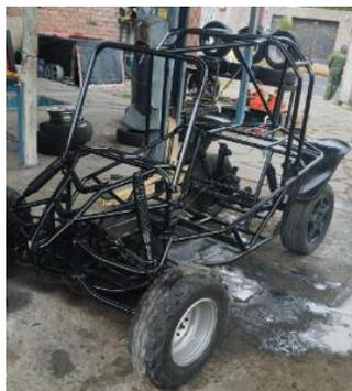
*Nota.* La figura 32 muestra el prototipo en el cual se va a realizar la implementación del sistema de tren de potencia y transmisión.
