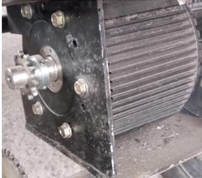
*Nota.* La figura 34 muestra la base cuadrada colocada en el motor. posteriormente se diseñó los soportes en el bastidor y en la base para la colocación del motor.
