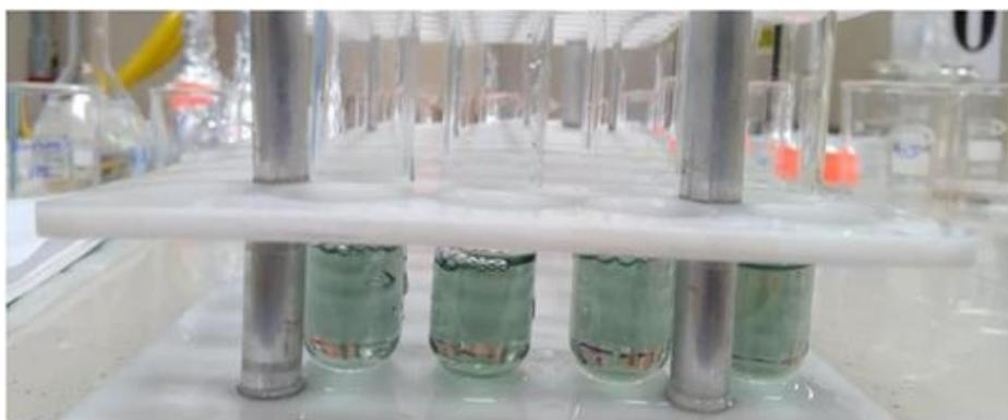
Luego, se llevaron los tubos de ensayo a baño María a 45°C durante 15 minutos. Finalmente se leyó la absorbancia a 765 nm en el espectrómetro de UV-VIS.
