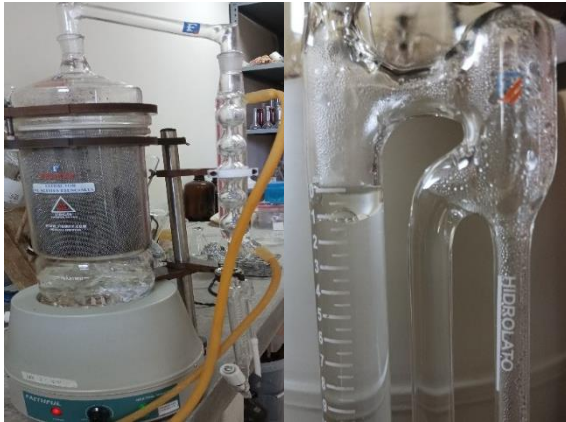
Figura 2 Extracción del aceite esencial de arrayán
