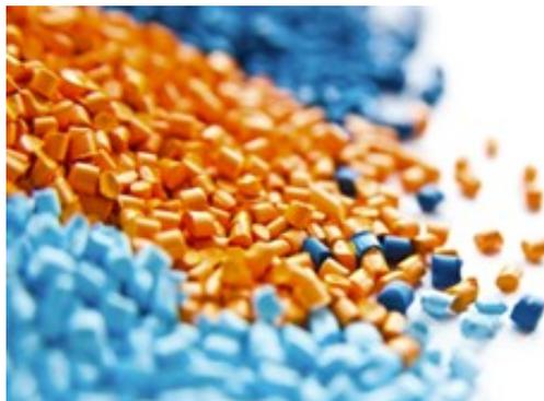
*Nota.* El gráfico representa los pellets obtenidos a través del proceso de extrusión y corte por una peletizadora.
