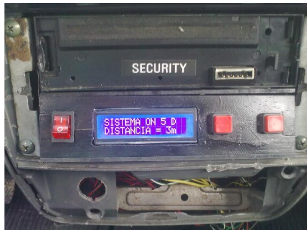
Figura 3.18. Tablero de mando en el panel frontal.
