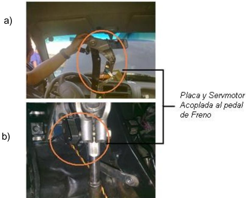
Figura 3.10 Servomotor de freno; a) Placa montada en el pedal de freno, b) Pedal de freno montado en el automóvil.
