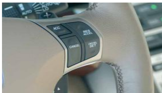
Figura 1.20 Panel de control en el volante.
