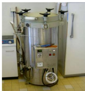
Fig. 2.5 Autoclaves de esterilización
