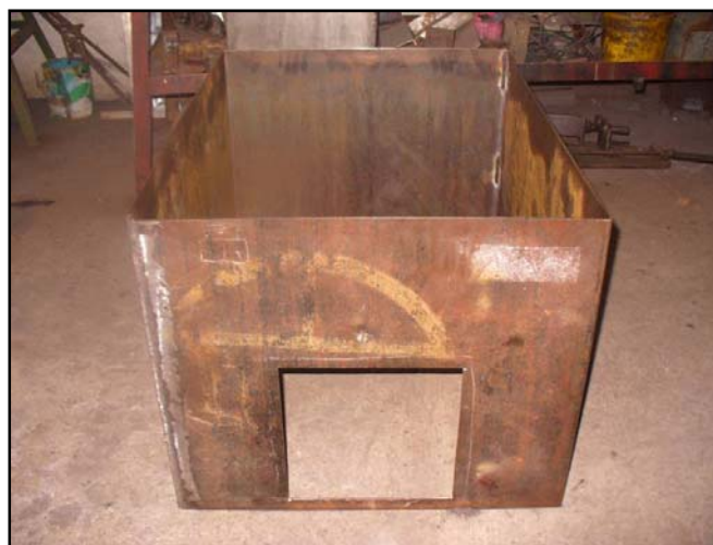
Figura 5. 21 Caja de Cenizas, Estructura
