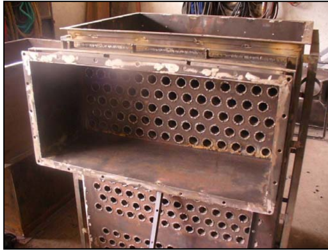
Figura 5. 11 Intercambiador de Calor, Ducto de entrada
