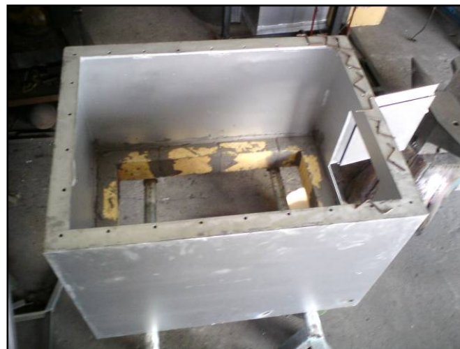
Figura 5. 4 Cámara de Combustión, Primera fila ladrillo refractario
