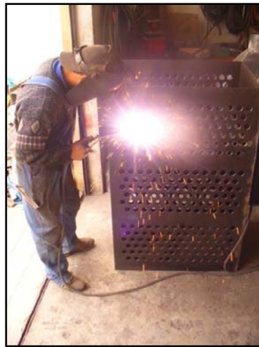
Figura 5. 9 Intercambiador de Calor, Soldadura de tubos
