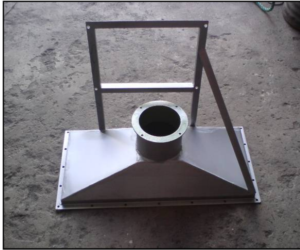
Figura 5. 41 Ducto para venterol de 6"
