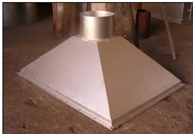
Figura 5. 28 Estructura del plenum terminada
