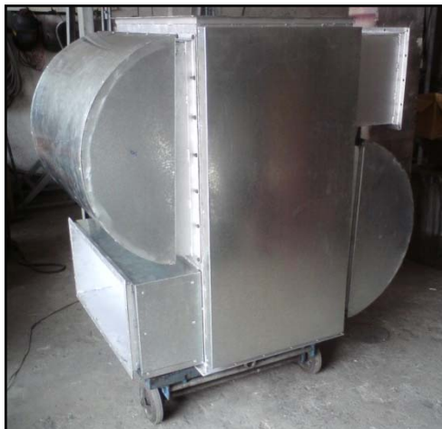
Figura 5. 15 Intercambiador de Calor con deflectores, frontal
