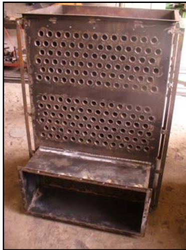
Figura 5. 12 Intercambiador de Calor, Terminado antes de pintura
