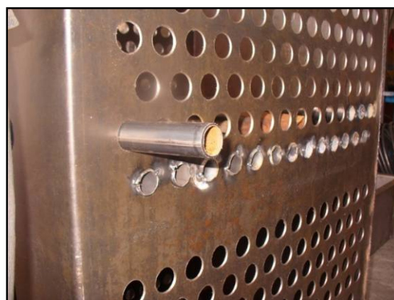
Figura 5. 7 Intercambiador de Calor, Montaje de tubos
