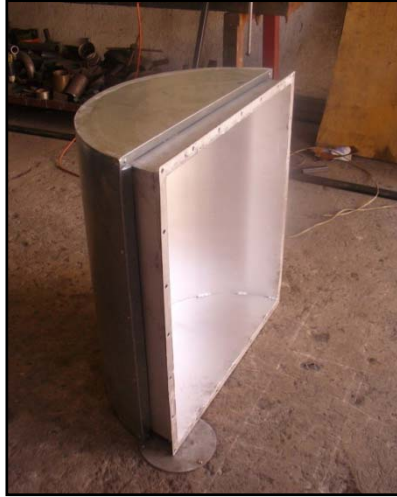
Figura 5. 14 Intercambiador de Calor, Deflector semicircular terminado
