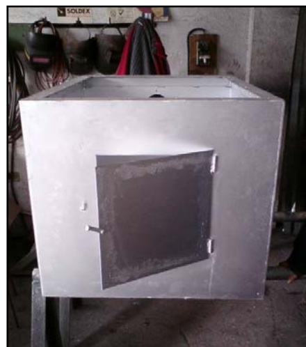
Figura 5. 2 Cámara de Combustión, Vista Frontal
