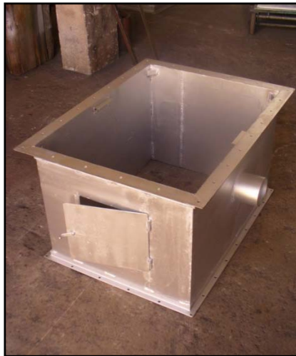
Figura 5. 19 Cámara de aire, Lateral-Frontal
