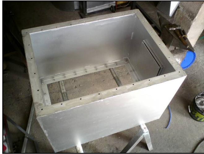
Figura 5. 3 Cámara de Combustión, Vista Superior
