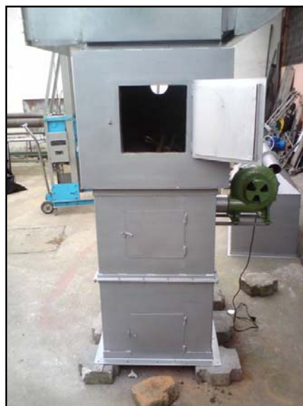
Figura 5. 47 Montaje de Venterol de 4" para combustión de Biomasa
