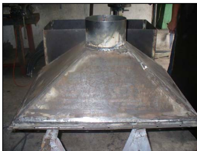
Figura 5. 25 Estructura del plenum
