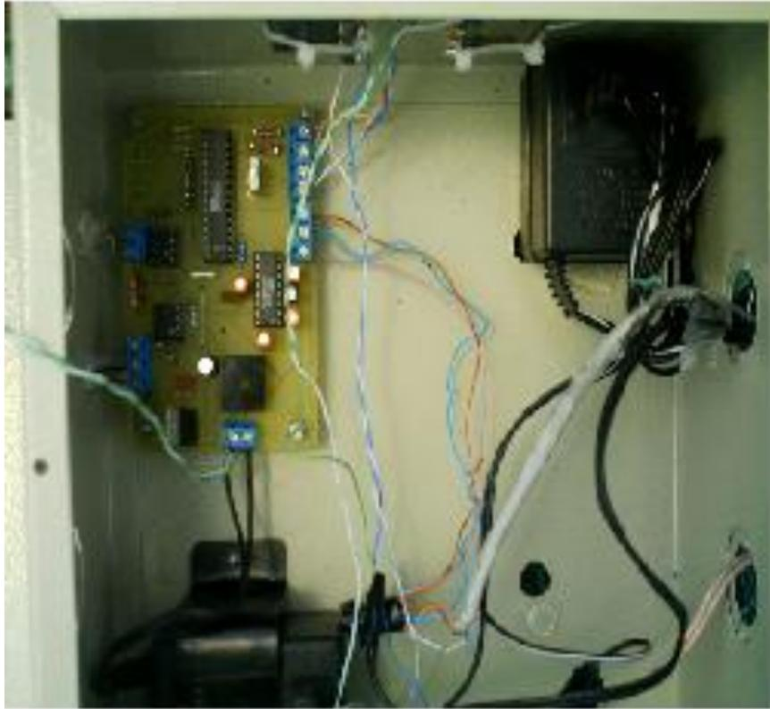
Figura 4.7: Circuito electrónico del control de temperatura
