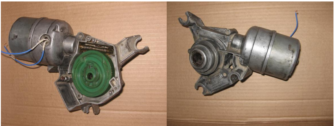
Figura 4.26 Conjunto motor – tornillo sinfin – corona original.
