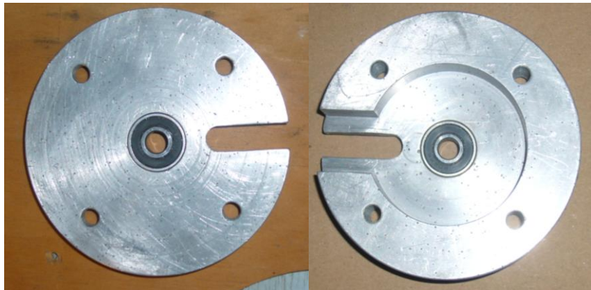
Figura 4.30 Montaje de los rodamientos en las tapas 1 y 2.
