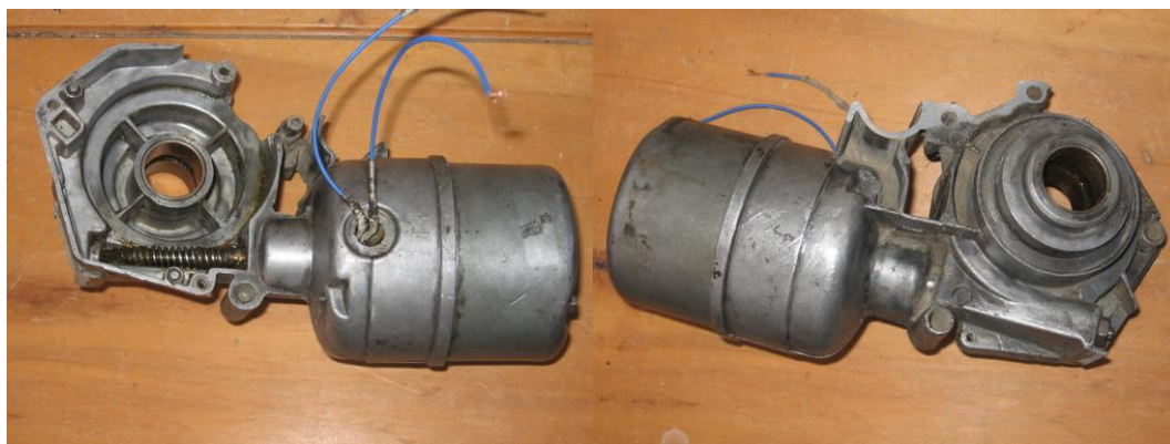
Figura 4.27 Conjunto motor – tornillo sinfin – corona cortado.
