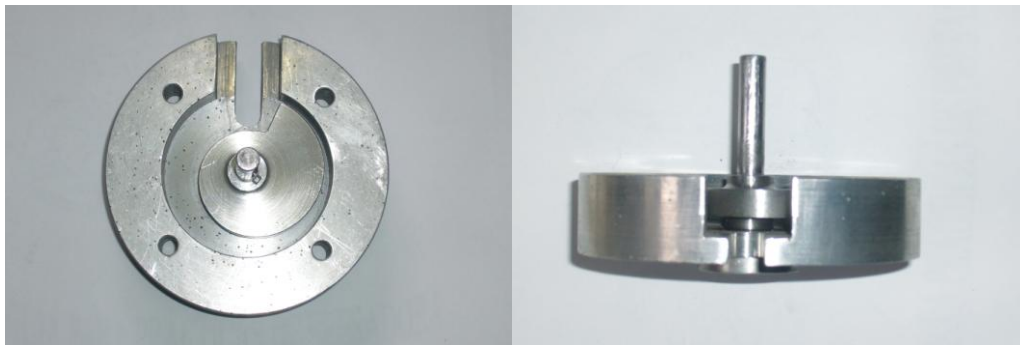
Figura 4.32 Montaje de la leva y eje en la tapa 2.
