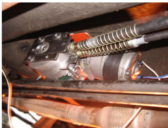
Figura 4.41 Disposición de los cables en el mecanismo.
