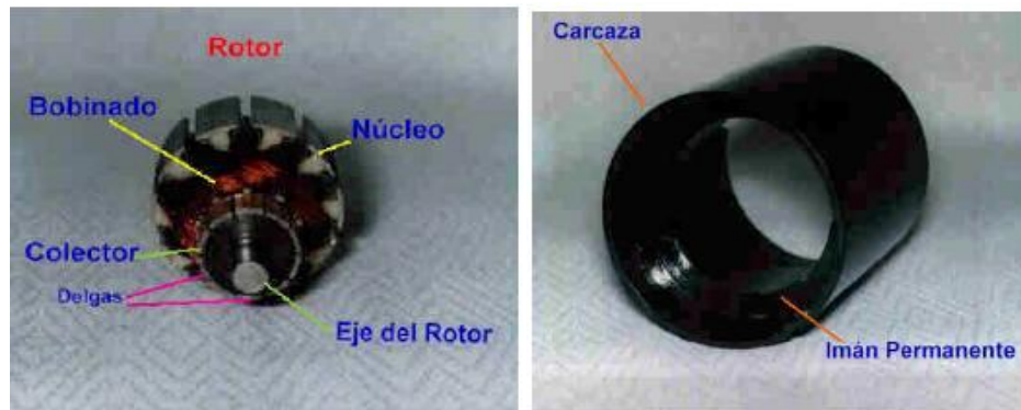
Figura 2.18 Partes de un motor de corriente continúa.
