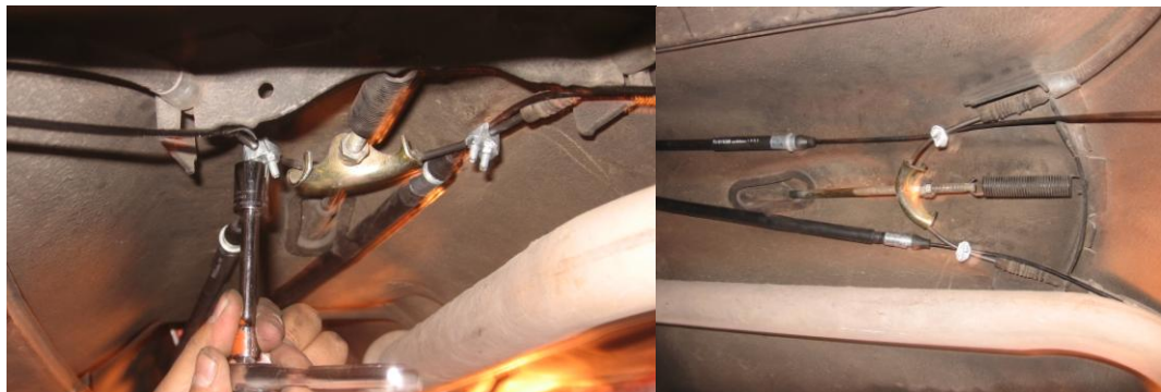
Figura 4.44 Acoplamiento del cable del mecanismo al cable del freno de mano.
