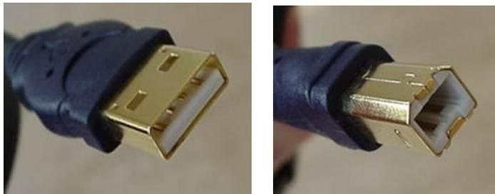
**Figura 1.14 Conector típico de USB, llamado conexión "A", y conexión tipo "B".**
