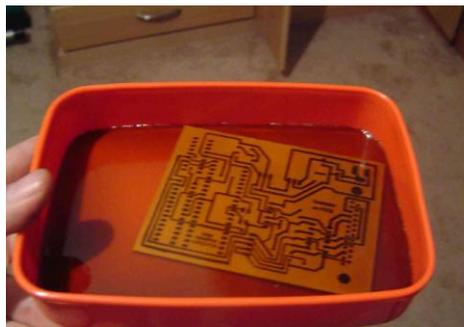
**Figura 2.55 Placa en recipiente, con el ácido.**
