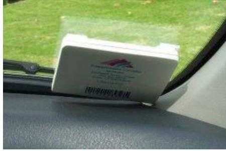
**Figura 1. 20 Etiqueta RFID utilizada para el cobro de peaje.**
