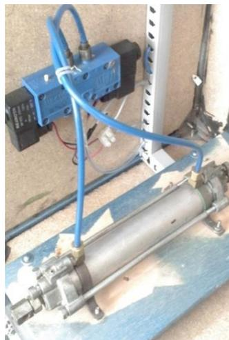
**Figura 4.11** Electroválvulas neumáticas.
