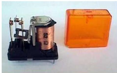
Figura 2.31 Estructura de un relé.
