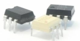
**Figura 2. 44 Optoacopladores encapsulados.**
