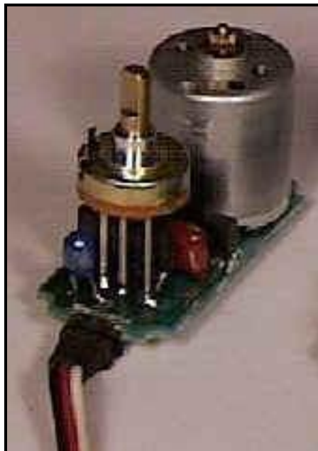
Figura Nº 2.20. Detalle del circuito de realimentación.
