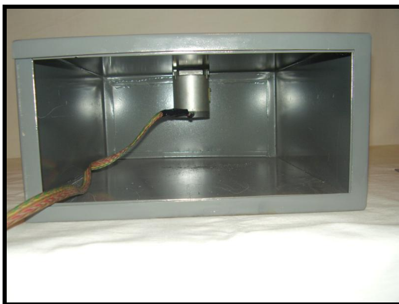
MONTAJE MOTOR PASO A PASO
