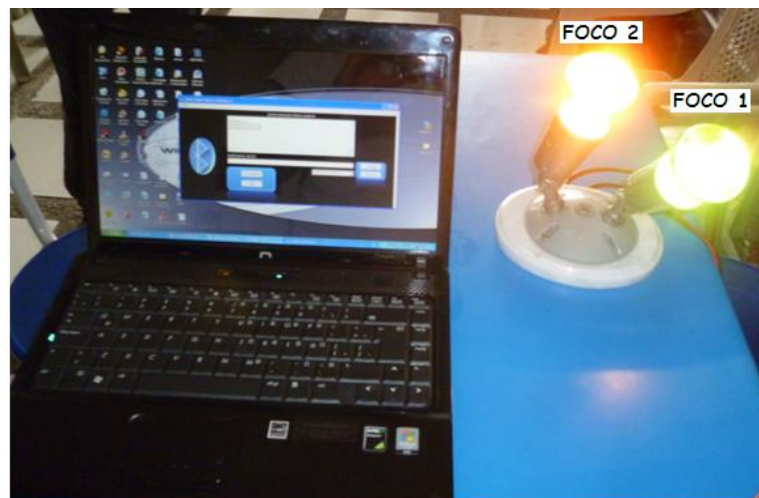
Figura 19 Activación de los dos dispositivos eléctricos
