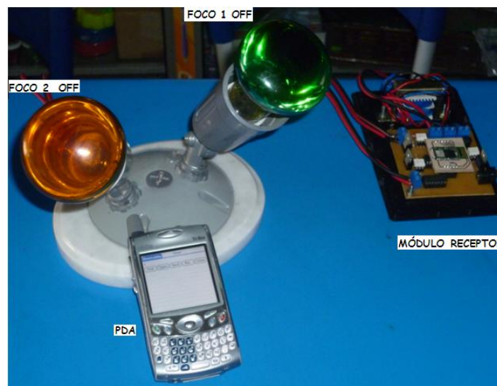
Figura 6 Desactivación de los dos Dispositivos Eléctricos
