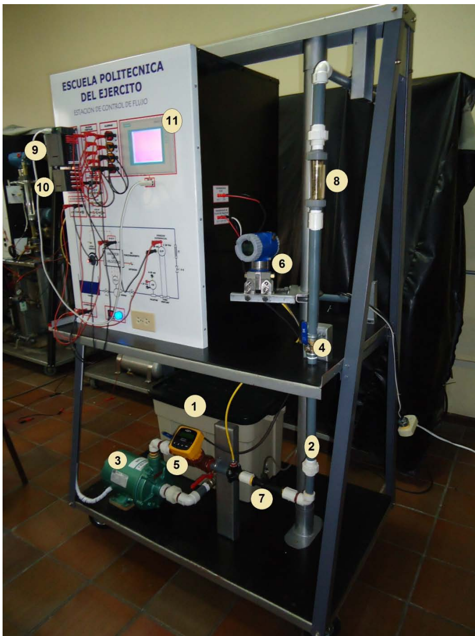
Figura 1 Componentes de módulo de control de flujo
