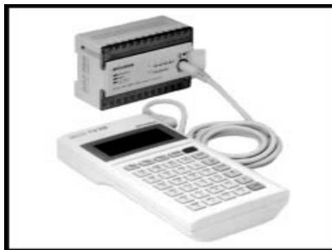
Figura 1. 24 PLC con unidad de programación de mano (Handheld) 2
