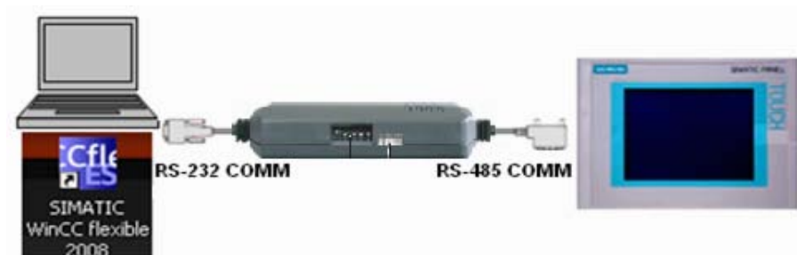
Figura 2. 73 Conexión física a través de cable PPI
