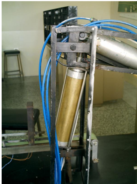
Cilindro B acoplado a la estructura del brazo neumático.
