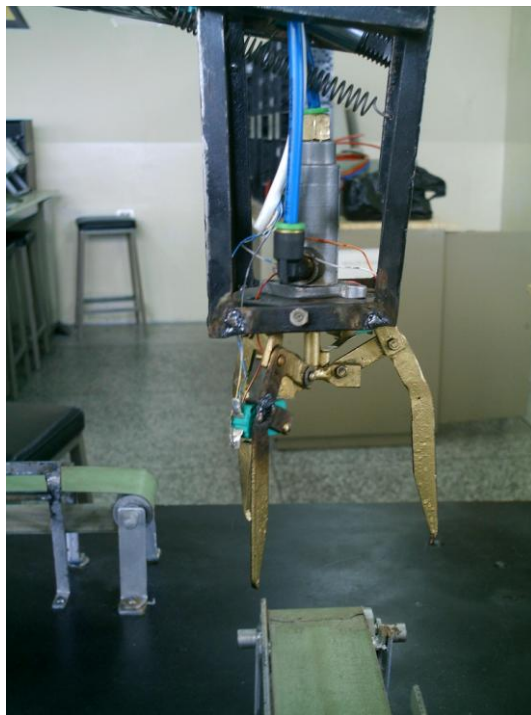
Cilindro D acoplado a la mano del brazo neumático.
