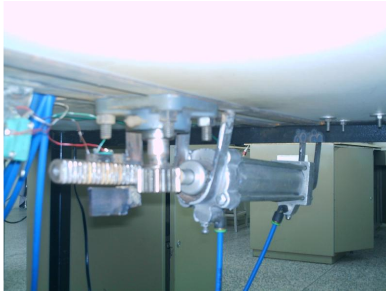
Cilindro A acoplado a la chumacera del brazo neumático.
