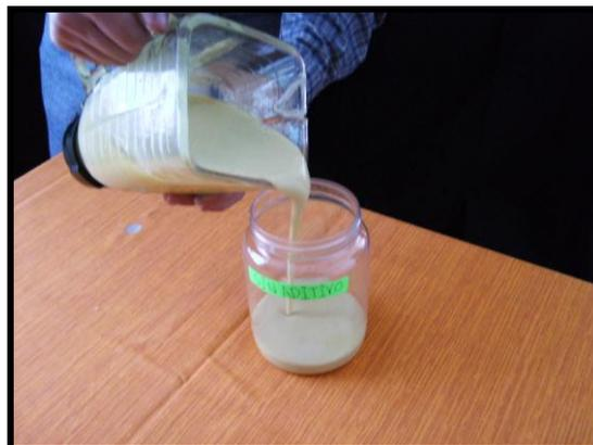
Este procedimiento lo repetimos con el lubricante sin aditivo y con el lubricante que tiene el doble de aditivo
