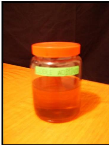
En este caso el lubricante tenia el doble de aditivo y no existe espuma pero la consistencia del lubricante cambio se hizo mas espeso.
