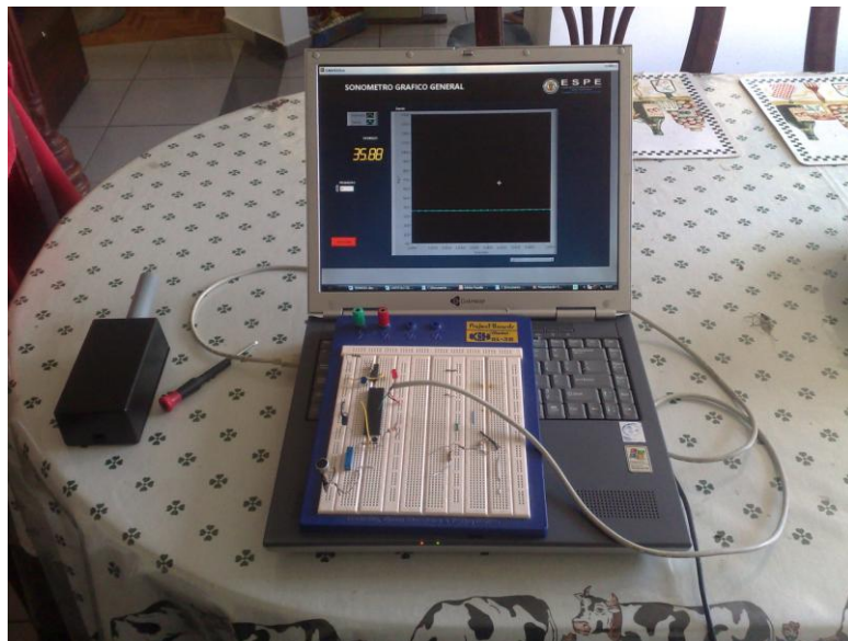
Figura 3.1 Sonómetro armado en protoboard para pruebas experimentales.
