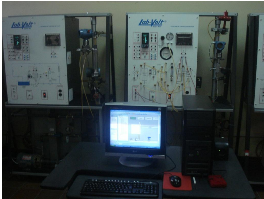
Figura 1. Configuración, monitoreo y supervisión de la Red HART
