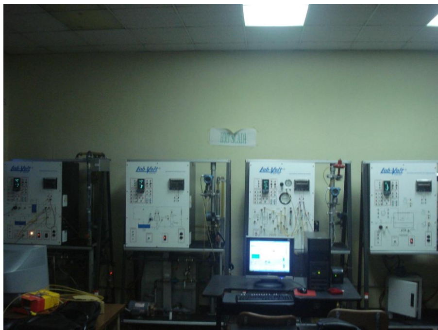
Figura 2. Red HART de transmisores inteligentes SMART
