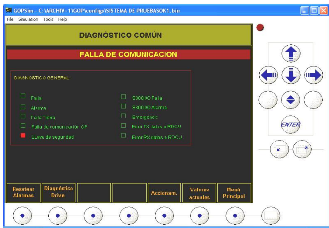
Pantalla de Diagnóstico Común del HMI del Sistema de Pruebas
