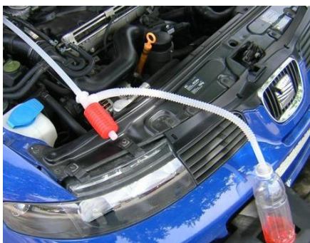
Figura 5.7: Extracción y almacenamiento del líquido refrigerante
