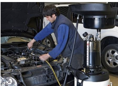
Figura 5.2: Recolector de aceite por succión
