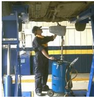
Figura 5.1: Recolector de aceite por gravedad
