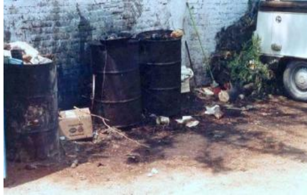
Figura 4.12: Almacenamiento de fluidos en un taller.
