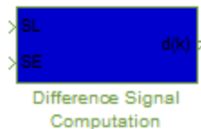
Figura 3.6. Bloque del cálculo de la diferencia de las señales de entrada y estimada.
