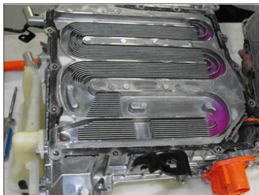
Figura 1.21 Conductos de refrigeración en el interior del Inversor
