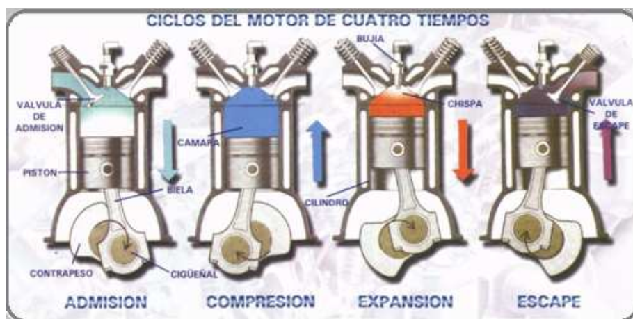
Figura 2.10 Motor cuatro tiempos
