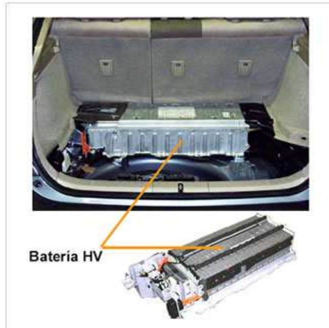
Figura 1.24 Cubierta Batería de Alta tensión
