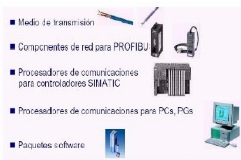
**Fig. 1.20 Componentes PROFIBUS.**
