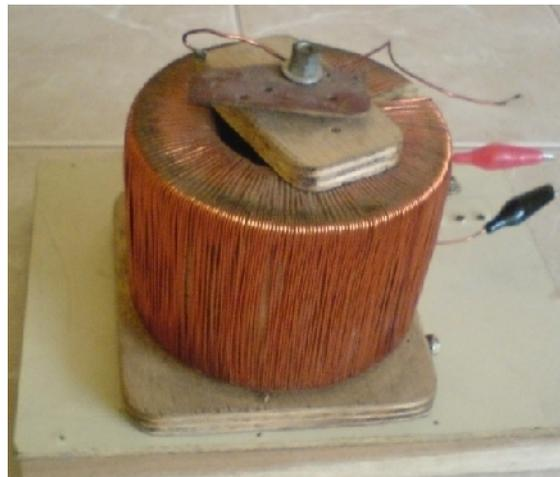
**Fig. 3.5 Aspecto físico de un reóstato.**
